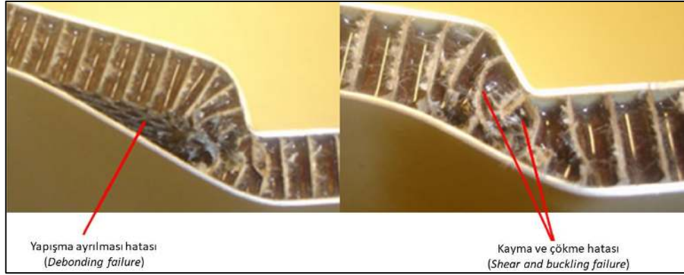
Şekil 1.7 Bal peteği yapılarda karşılaşılan yaygın hata türleri [8]
