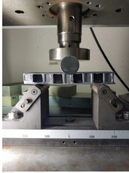
Şekil 4.10. Üç nokta eğme testine maruz bırakılan numune
