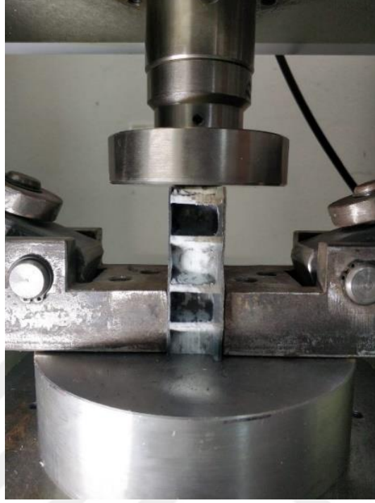
Şekil 4.9. Düzlem içi basma testine maruz bırakılan numune
