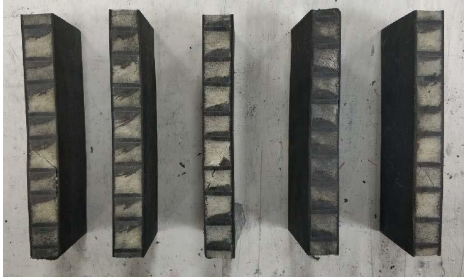
Şekil 5.15. Üç nokta eğme testi sonrası poliüretan köpük dolgulu çekirdeğe sahip numunelerde meydana gelen hasarlar
