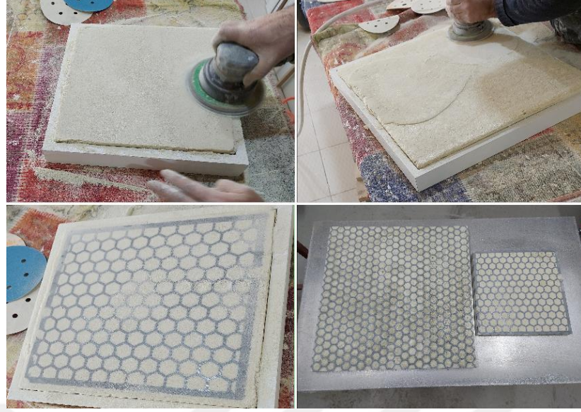
Şekil 4.6. Çekirdek yapının istenen forma getirilmesi adına uygulanan zımparalama işlemi
