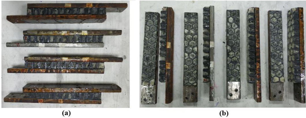
Şekil 5.22. Poliüretan köpük dolgulu bal peteği çekirdekli sandviç numuneler için (a) kesme testi öncesi numuneler, (b) kesme testi sonrası numuneler
