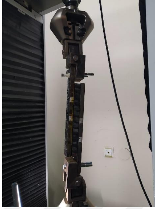
Şekil 4.11. Kesme testine maruz bırakılan numune
