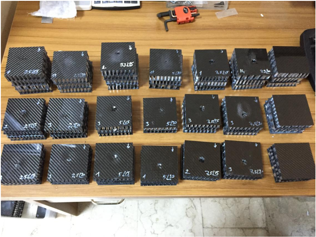
Şekil 3.21. Bal peteği sandviç kompozitlere uygulanan açılı darbe testleri sonucu numunelerin önden görünüşü
