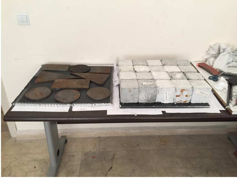
Şekil 3.6. Karbon fiber takviyeli bal peteği sandviç kompozitlerin ağırlık altında bekletilmesi
