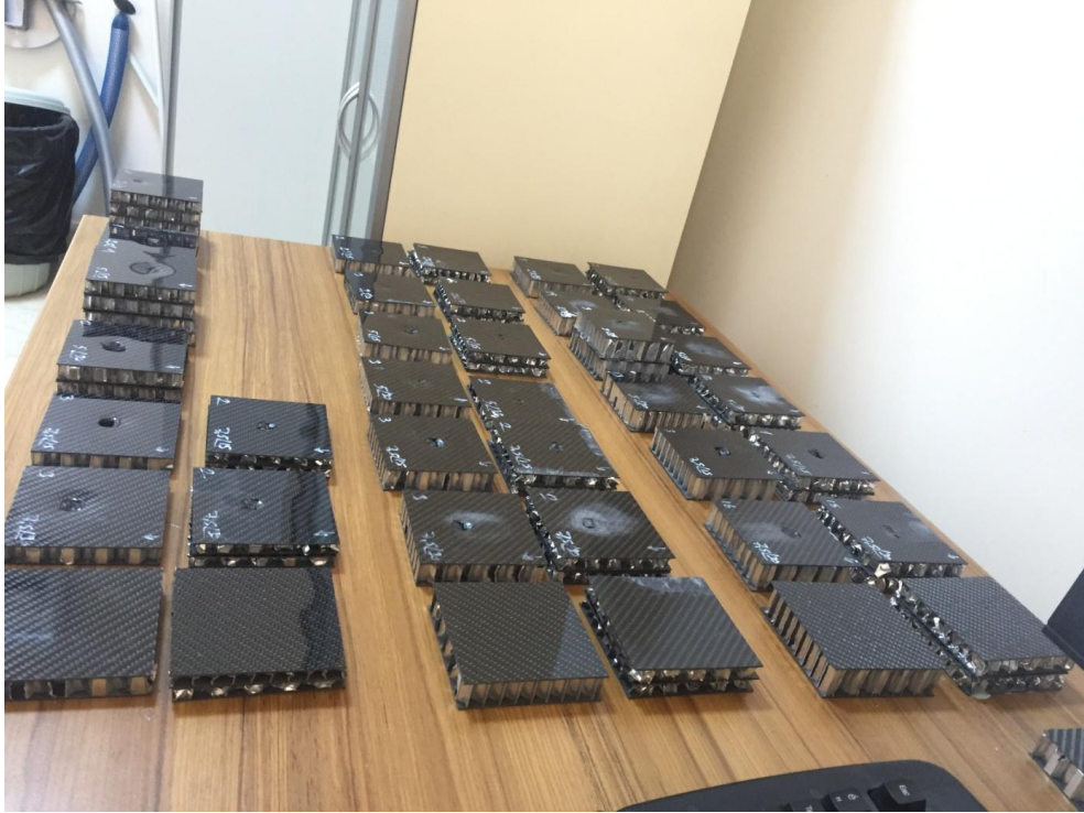
Şekil 13. Karbon fiber takviyeli bal peteği sandviç kompozit numunelerin Darbe ve Basma testi sonrası hasarlı ve hasarsız görüntüleri
