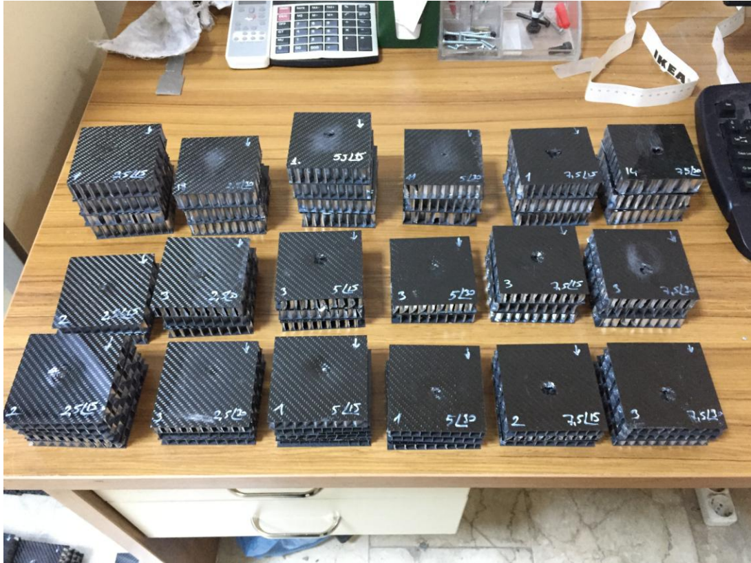
Şekil 3.18. Bal peteği sandviç kompozitlere uygulanan açılı darbe testleri sonucu numuneler
