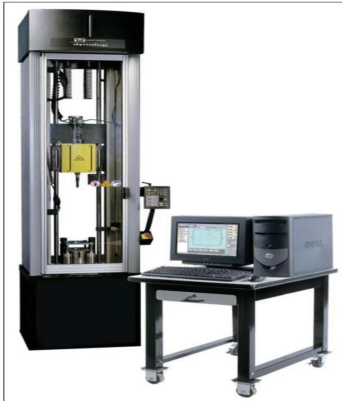
Şekil 3.15. Instron Dynatup 9250 ağırlık düşürme test düzeneği (Evci, 2009)
