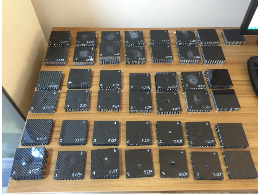
Şekil 3.27. 10 mm, 15 mm ve 20 mm hücre yüksekliğine sahip bal peteği sandviç kompozitlerin basma testi sonrası önden görünüşleri-2
