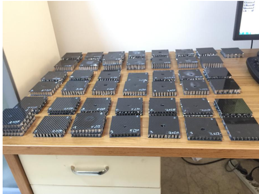
Şekil 3.26. 10 mm, 15 mm ve 20 mm hücre yüksekliğine sahip bal peteği sandviç kompozitlerin basma testi sonrası önden görüşleri
