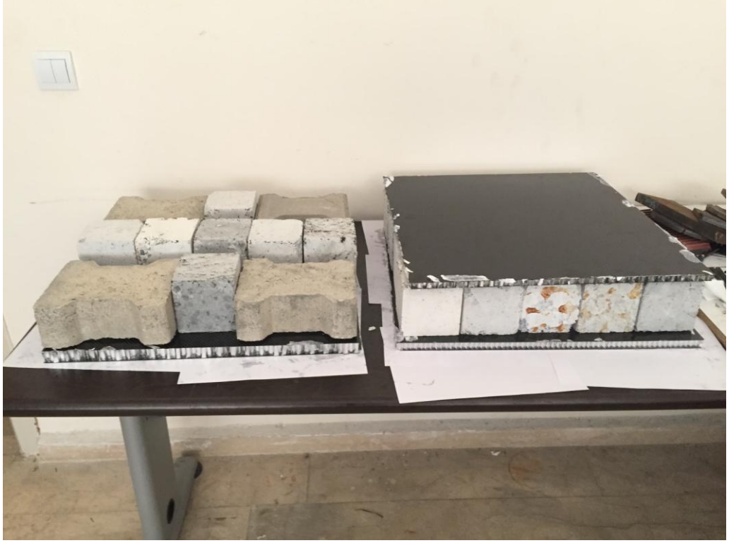
Şekil 3.7. Karbon fiber takviyeli bal peteği sandviç kompozitlerin ağırlık altında bekletilmesi-2
