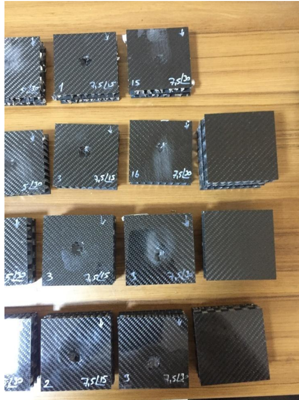
Şekil 4. Karbon fiber takviyeli bal peteği sandviç kompozit numunelerin Darbe ve Basma testi sonrası hasarlı ve hasarsız görüntüleri
