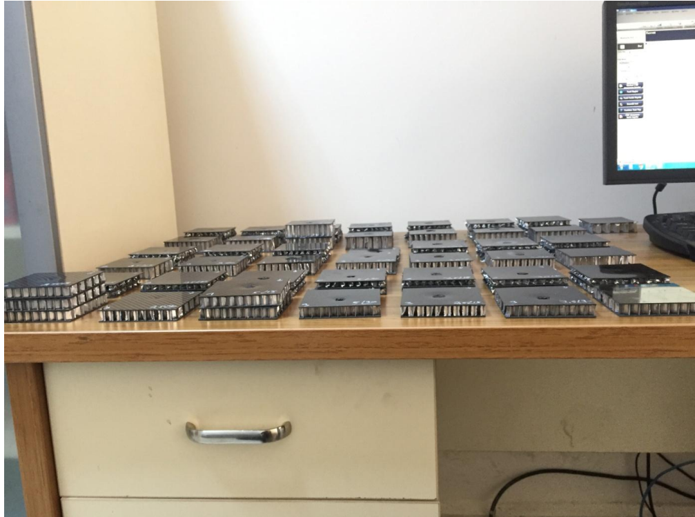
Şekil 15. Karbon fiber takviyeli bal peteği sandviç kompozit numunelerin Darbe ve Basma testi sonrası hasarlı ve hasarsız görüntüleri
