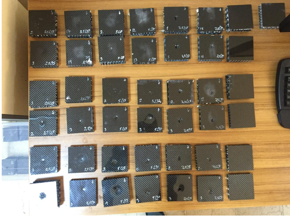
Şekil 14. Karbon fiber takviyeli bal peteği sandviç kompozit numunelerin Darbe ve Basma testi sonrası hasarlı ve hasarsız görüntüleri
