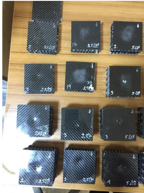
Şekil 2. Karbon fiber takviyeli bal peteđi sandviç kompozit numunelerin Darbe ve Basma testi sonrası hasarlı ve hasarsız görüntüleri
