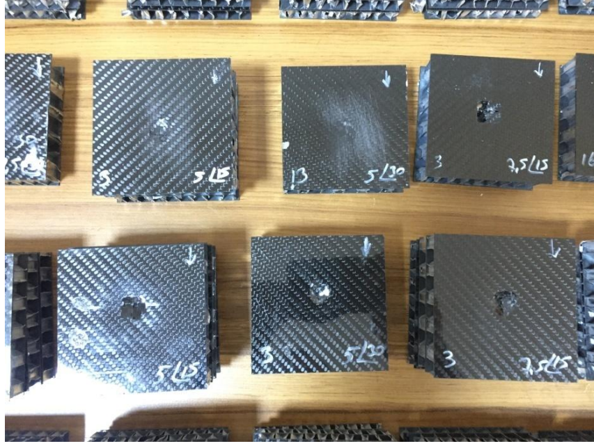
Şekil 5. Karbon fiber takviyeli bal peteği sandviç kompozit numunelerin Darbe ve Basma testi sonrası hasarlı ve hasarsız görüntüleri
