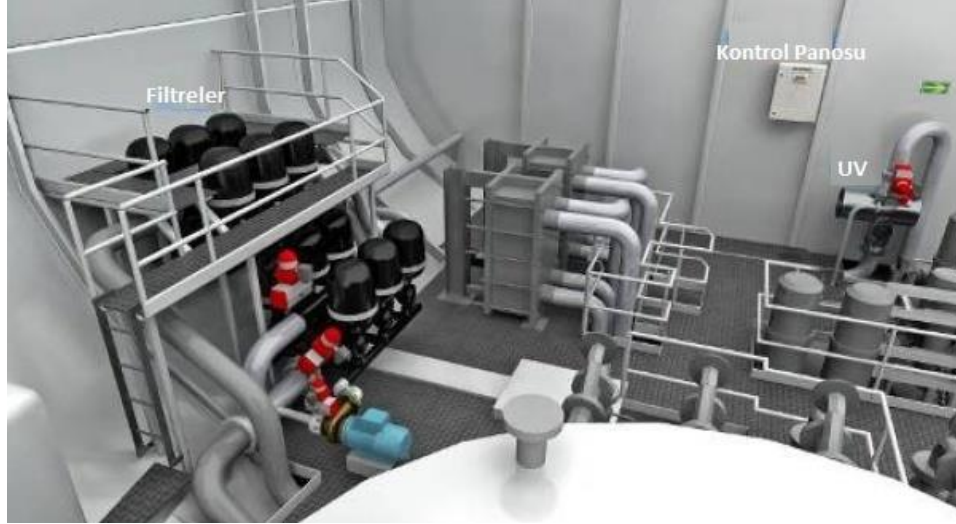
Şekil 6.2 : Balast suyu arıtma sisteminin gemide modüler olarak yerleşimi [140].
