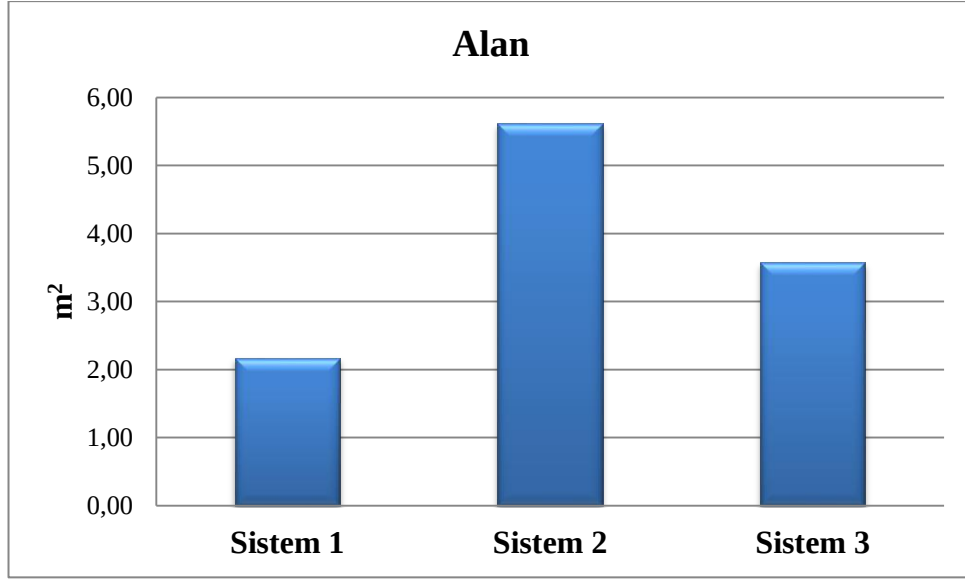
Şekil 7.6 : Balıkçı gemisi için değerlendirilen balast suyu arıtma sistemlerinin kapladığı alanların karşılaştırmaları
