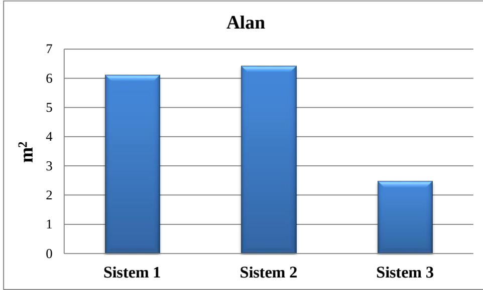
Şekil 7. 18 : Kuru yük gemisi için değerlendirilen balast suyu arıtma sistemlerinin kapladığı alanların karşılaştırmaları.
