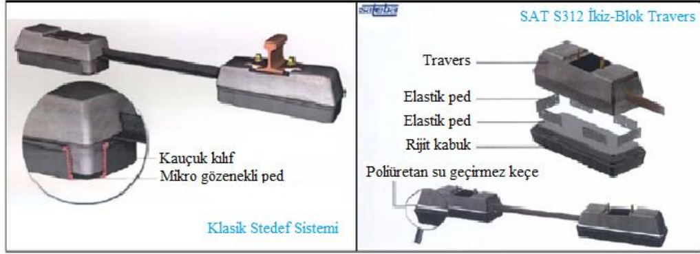
Şekil 3.11 : Klasik ve Sabeta 312 Stedef üstyapı sistemi (Dieleman ve diğ. 2008).
