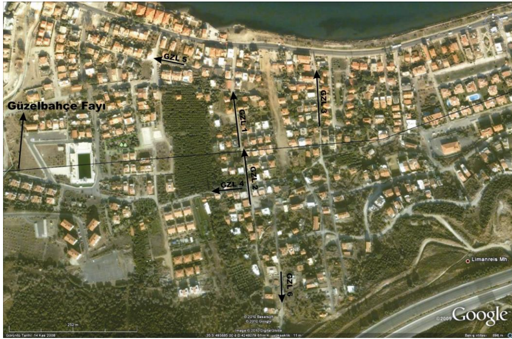
Şekil 4.89 Güzelbahçe istasyonu çevresinde denize dik ve paralel MASW ölçü profilleri.
