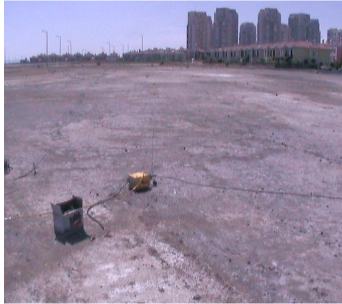
Şekil 4.169 Mavişehir istasyonunda yapılan Masw çalışmalarını gösteren fotoğraf.
