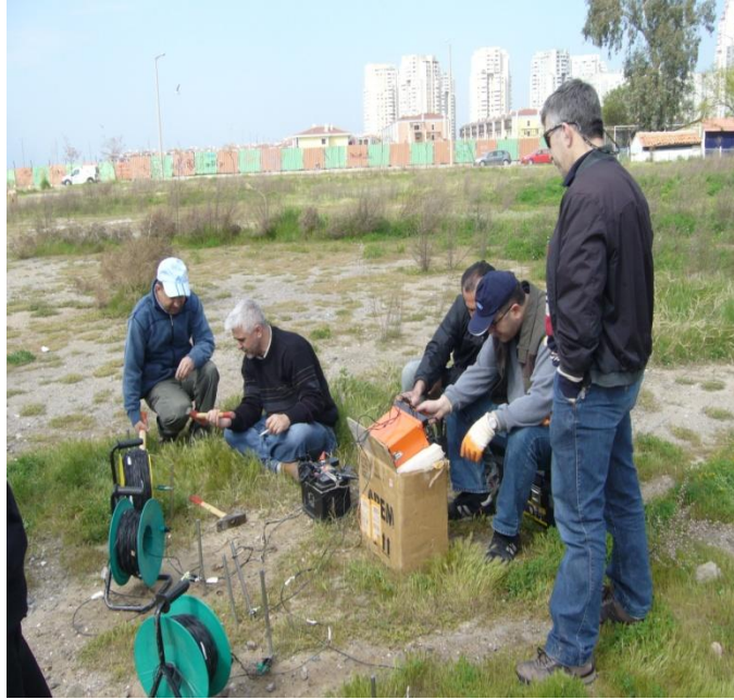
Şekil 4.15 Elektrik Özdirenç Yöntemi arazi uygulamaları
