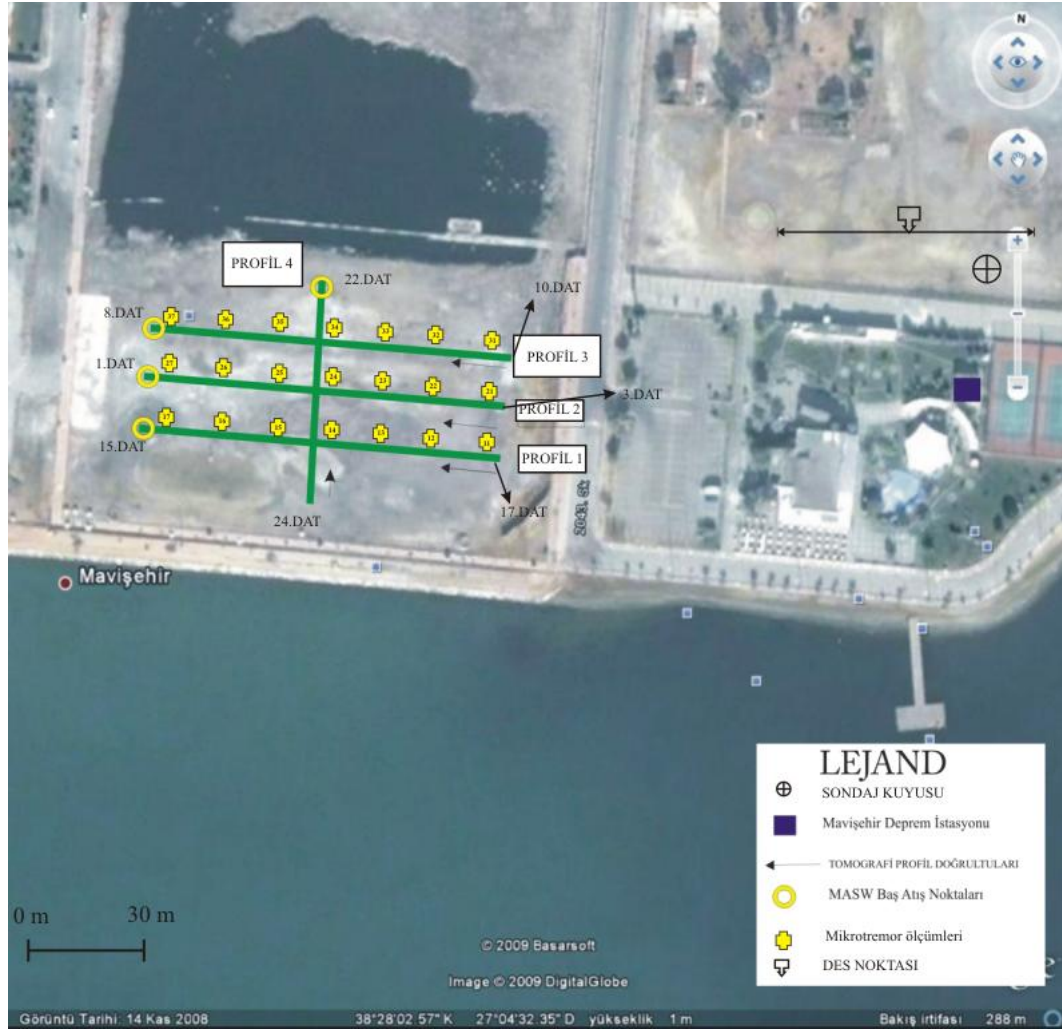
Şekil 4.167 Mavişehir istasyonunda yapılan genişletilmiş çalışmalar.
