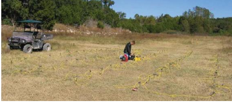
Şekil 3.3 Çok elektrotlu öz direnç cihazı ile arazide ölçü alımı.
