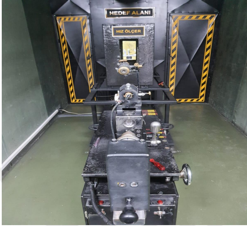
Şekil 4.1. Balistik Test Laboratuvarı'nda bulunan silah ve kronograf düzeneği.
