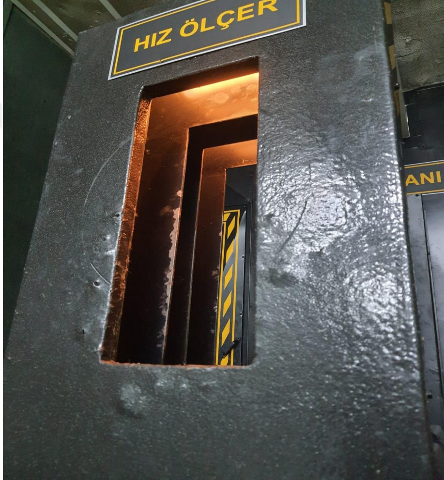
Şekil 2.2. Oehler 35P kronografin polikarbonat çerçeve sayesinde kanal yapısından dolayı iç kısmında bulunan aydınlatma.
