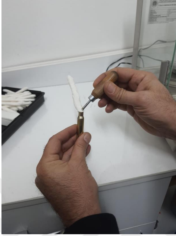
Şekil 3.5 Barutun kovan içerisinde sıkıştırılması.
