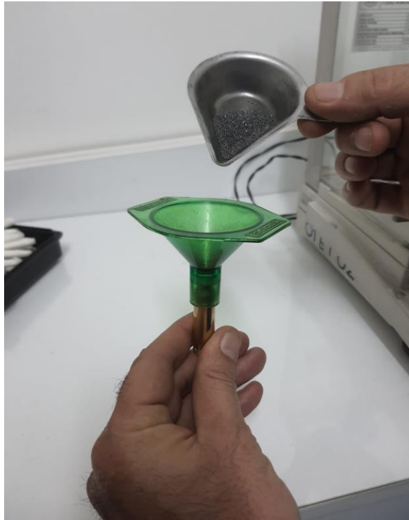
řekil 3.4 Barutun kovana doldurulması.
