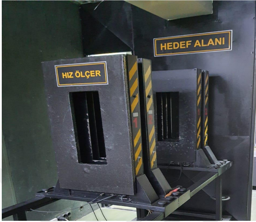
Şekil 2.1. Oehler 35P kronograf. Öndeki hız ölçer namlu çıkış hızını ölçerken, arkadaki hız ölçer ise numuneye çarpma hızını ölçmektedir.
