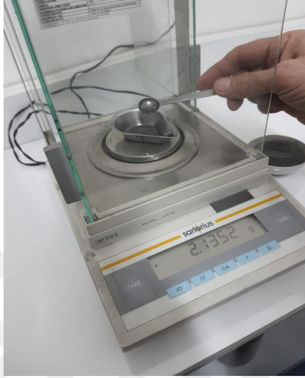
řekil 3.3 Barutun gram ağırlıkta ayarlanması.
