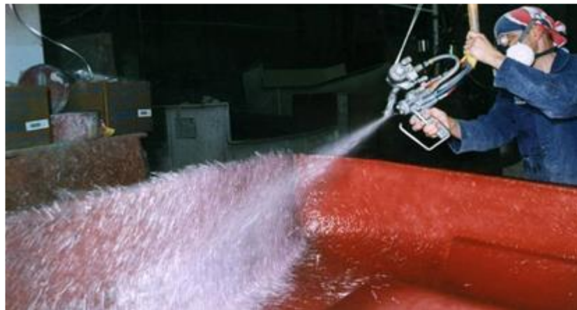
Şekil 2.4 Püskürtme Yöntemi (Composite Manufacturing, 2015)
