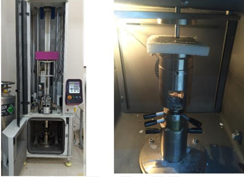
Şekil 2.10 Düşük hız darbe test cihazı (Kişisel arşiv, 2020)
