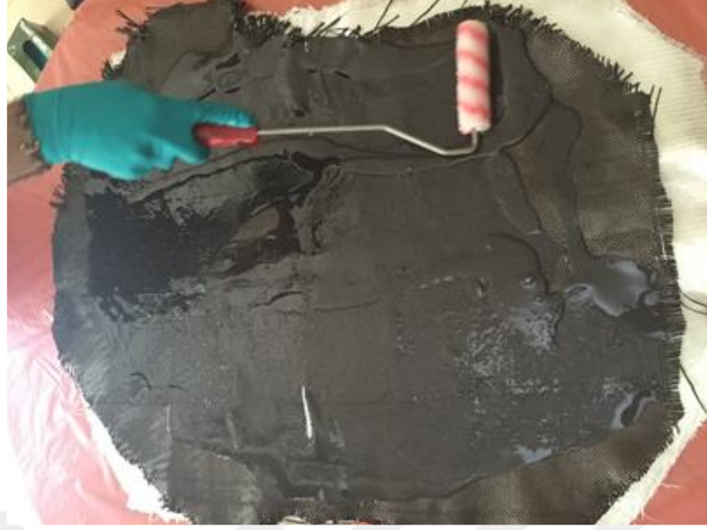
Şekil 2.2 Elde yatırma yönteminde kumaşa reçine emdirilmesi (Kişisel arşiv, 2016)
