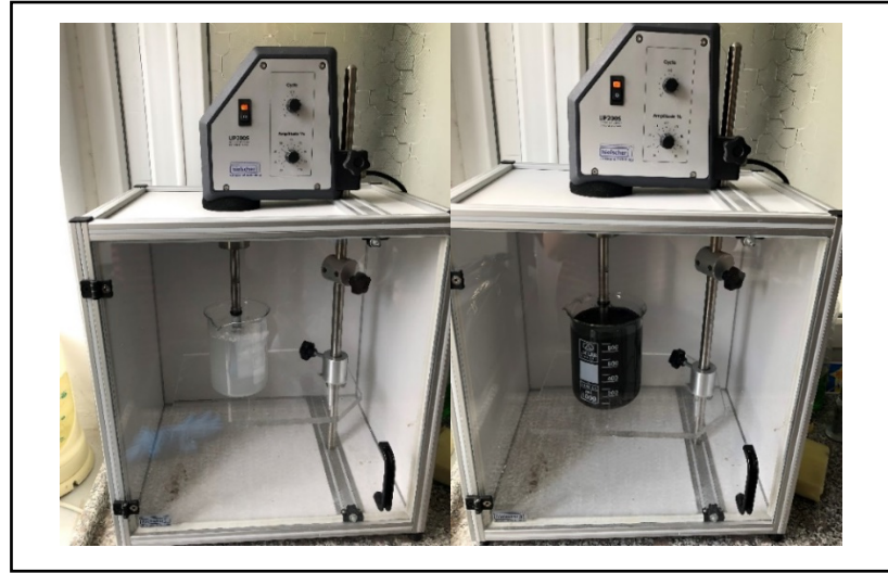
Şekil 2.13 Çok tabakalı kaplama yönteminde uygulanan ön işlem (Kişisel arşiv, 2019)
