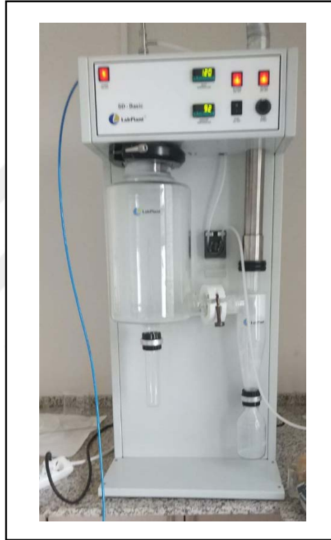
Şekil 2.10 Mikrokapsül üretiminde kullanılan püskürterek kurutma cihazı (Kişisel arşiv, 2019)
