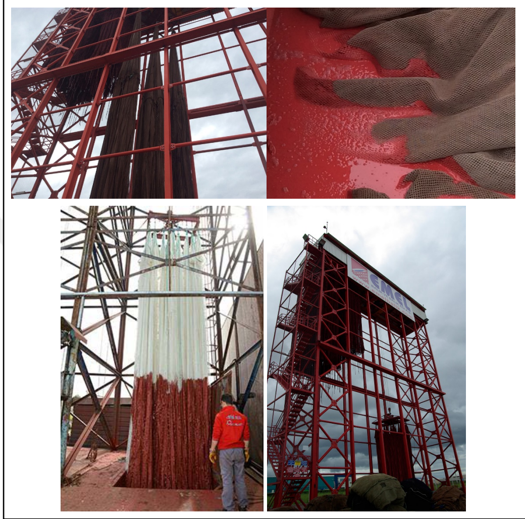
Şekil 2.7 Kafes balıkçılığında kullanılan balık ağlarının bakır(I)oksit içeren boyalar ile boyanma işlemi (Emel Balık, 2020)
