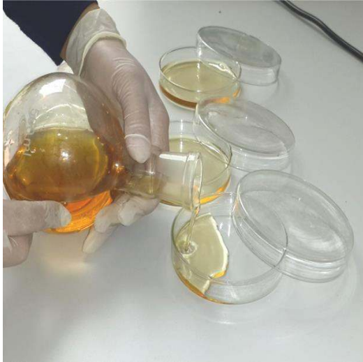
Fotoğraf 3.18. Tripton Soya Agar’ın petri kutularına boşaltılması
