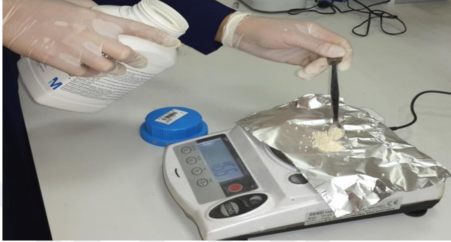
Fotoğraf 3.15. Triptik soya Agar tozunun istenen ağırlıklarda Hazırlanması
