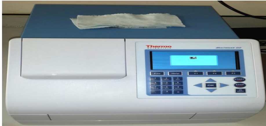
Fotoğraf 3.31. Thermo Scientific™ Multiskan™ GO Mikro plaka okuyucu Spektrometre.
