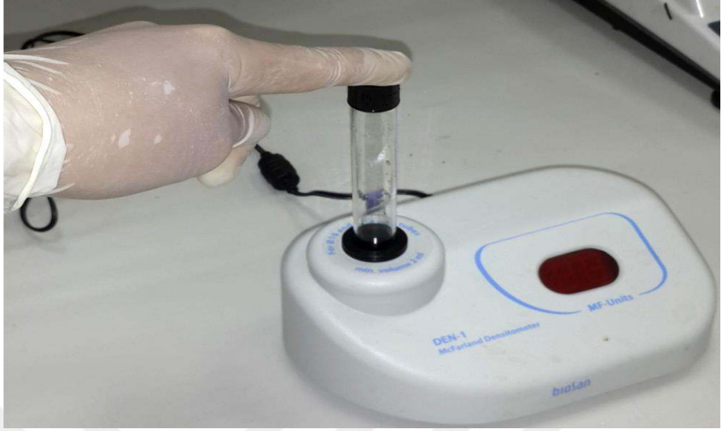
Fotoğraf 3.21. 0,5 McFarland çözeltisine eklenen 1 \times 10^8 CFU ml -1 içeren inoklum
