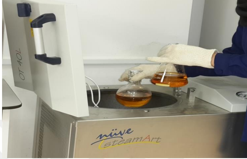
Fotoğraf 3.17. Triptik Soya Agar’ın Otoklavlanması
