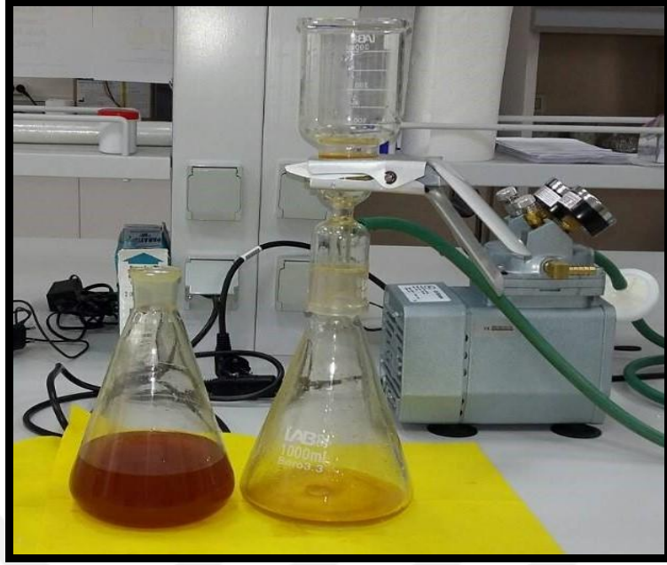
Fotoğraf 3.4. Vakum birimleri kullanarak filtreleme.
