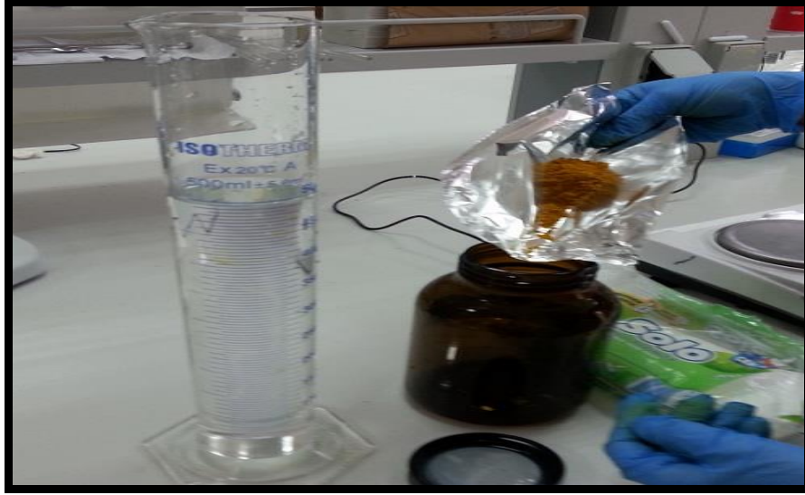
Fotoğraf 3.2. 1 L Methanol (40%) ile karıştırılması
