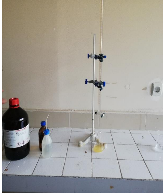
Şekil 4.3. Titrasyon deney düzeneği
