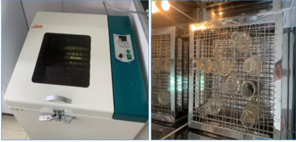
Şekil 3.4. Numuneye Adsorban Katıldıktan Sonra Karıştırıcıya Koyulması
