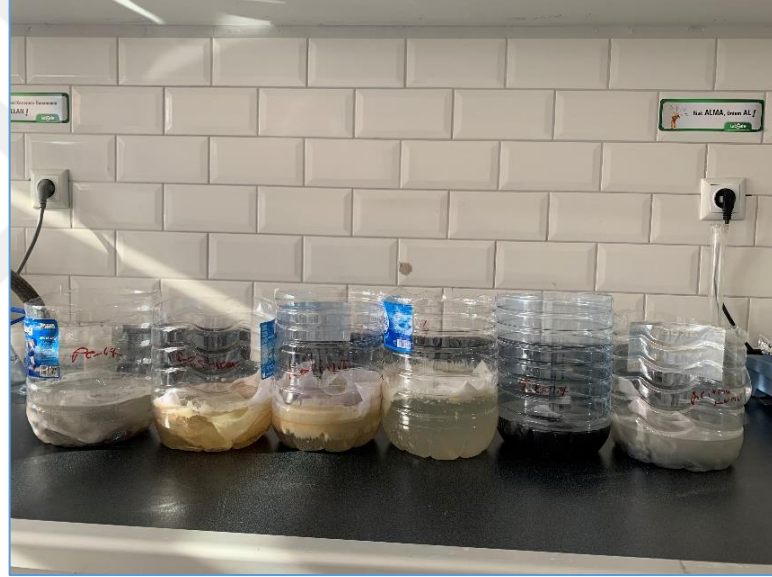
Şekil 3.3. Balıkçı Barınağından Alınan Deniz Suyuna Adsorban Katılması
