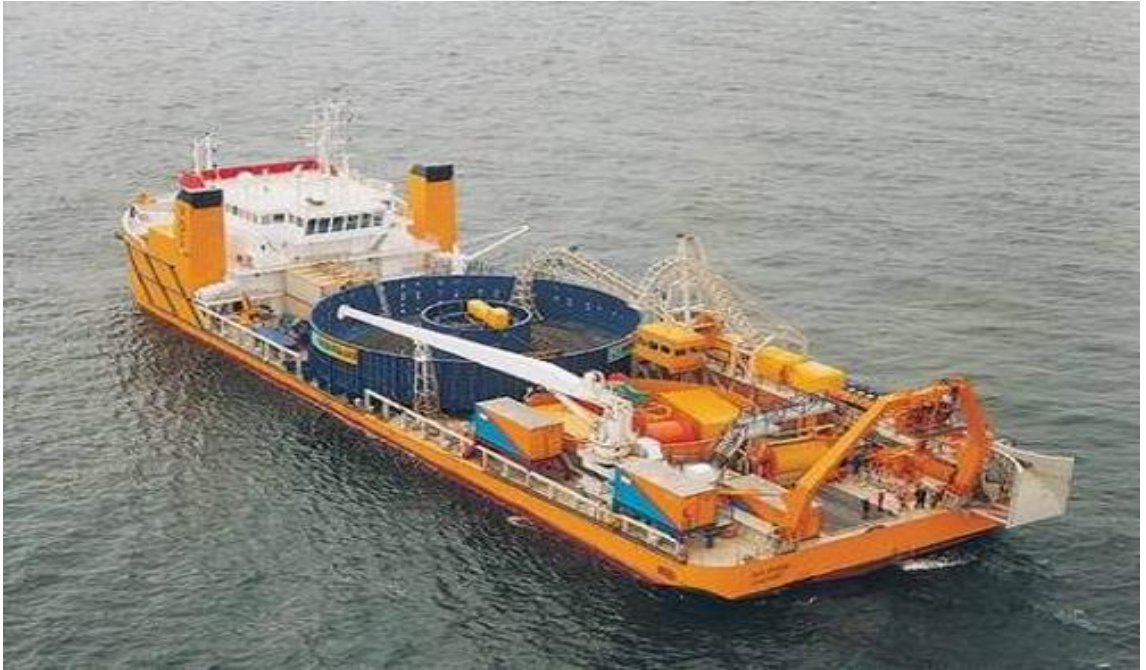
Şekil 30. Kablo döşeme gemisi (URL-27)
