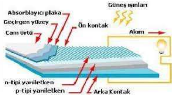
Şekil 2.4. Fotovoltaik hücrenin iç yapısı [36-38]
