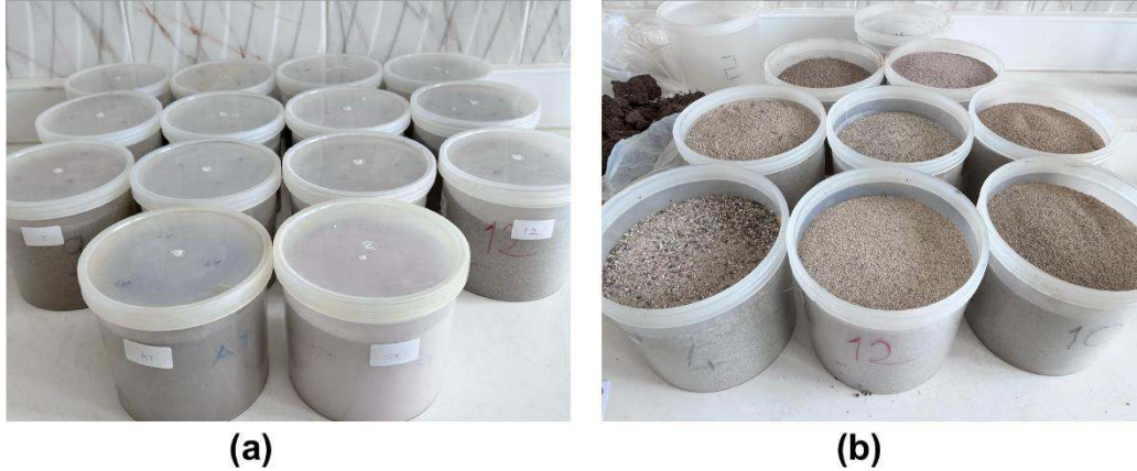
Şekil 3.2. Badavut bölgesinden temin edilen toprak numunelerinin görseli. (a) Sayıma hazır durumdaki numuneler (b) Marinelli kaplarına konulmuş toprak numuneleri.
