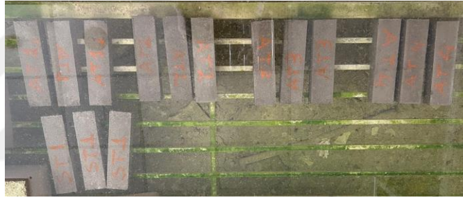
Şekil 3.9. Farklı oranlarda Sarımsaklı ve Ahlat Taş tozlarını içeren üçlü setler halindeki beton numunelerin kürleme süreci için su tankı içerisine bırakılmış halinin resmi
