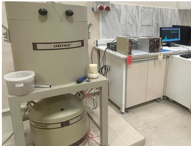
Şekil 2.10. Bitlis Eren Üniversitesi Bilim ve Teknoloji Uygulama ve Araştırma Merkezi Fizik Laboratuvarında bulunan ORTEC marka HPGe dedektör sisteminin görseli.
