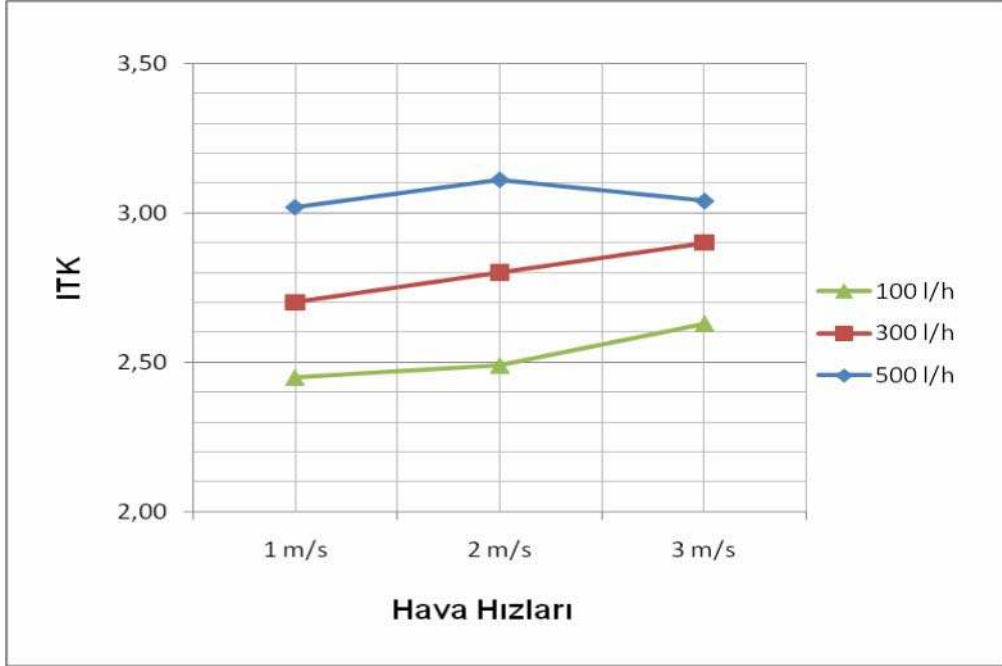
Şekil 8.2. 1. hava şartında hava hızına ve su debisine bağlı olarak ITK değişimi
