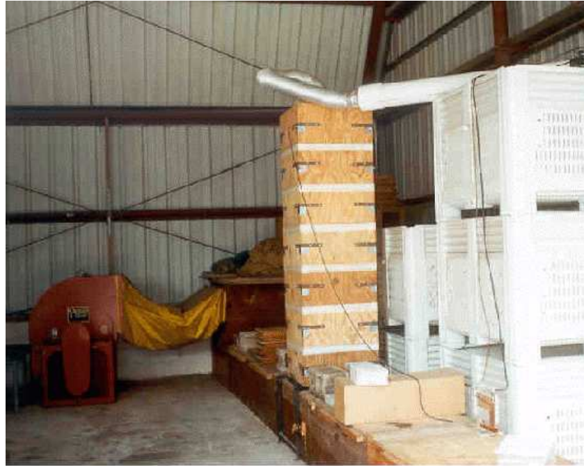
Şekil 2.16. Soğanın havaya karşı göstermiş olduğu direnci ölçme sistemi
