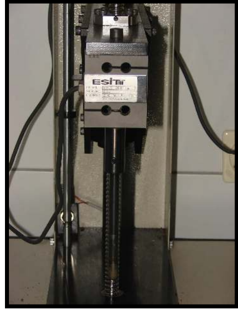
Şekil 3.6. Biyolojik özellikler ölçme materyal test düzeneği çene ve yük hücresi
