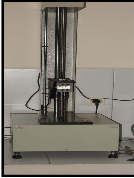
Şekil 3.6. Biyolojik özellikler ölçme materyal test düzeneği çene ve yük hücresi
