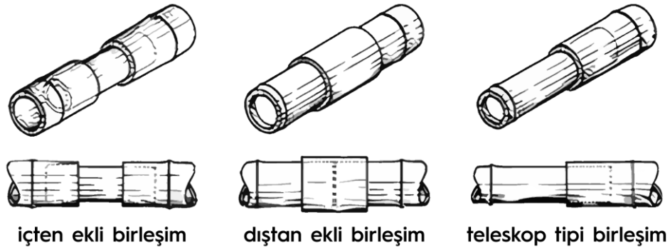
Şekil 21. Birbirinin içine geçmeli birleşim yöntemiyle uç uca eklenen bambular (López, 2003)
