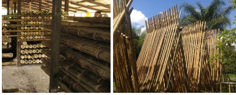
Şekil 8. Yatay veya dikey olarak havayla kurutma (URL-7, 2023)
