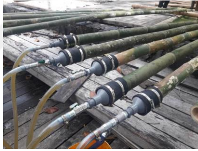
Şekil 11. Boucherie yöntemi ile kurutma (URL-11, 2024)
