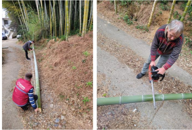
Şekil 61. Bambuların kesildikten sonra 5 m'lik üç alt gruba ayrılması
