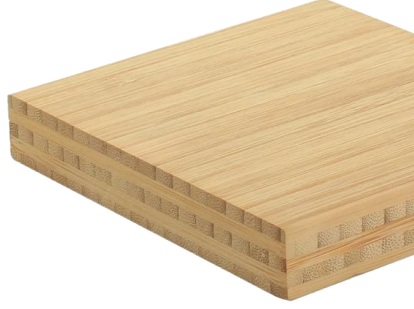
Şekil 15. Çapraz lamine bambu (CLB) (URL-13, 2024)
