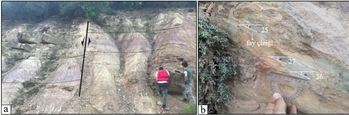
Şekil 6.9 Miyosen yaşlı Yeniköy Formasyonunu kesen sağ yanal fay düzlemi, K64B/76KD R:25K, K62B/75KD R:26K, K62B/81KD R:27K.
