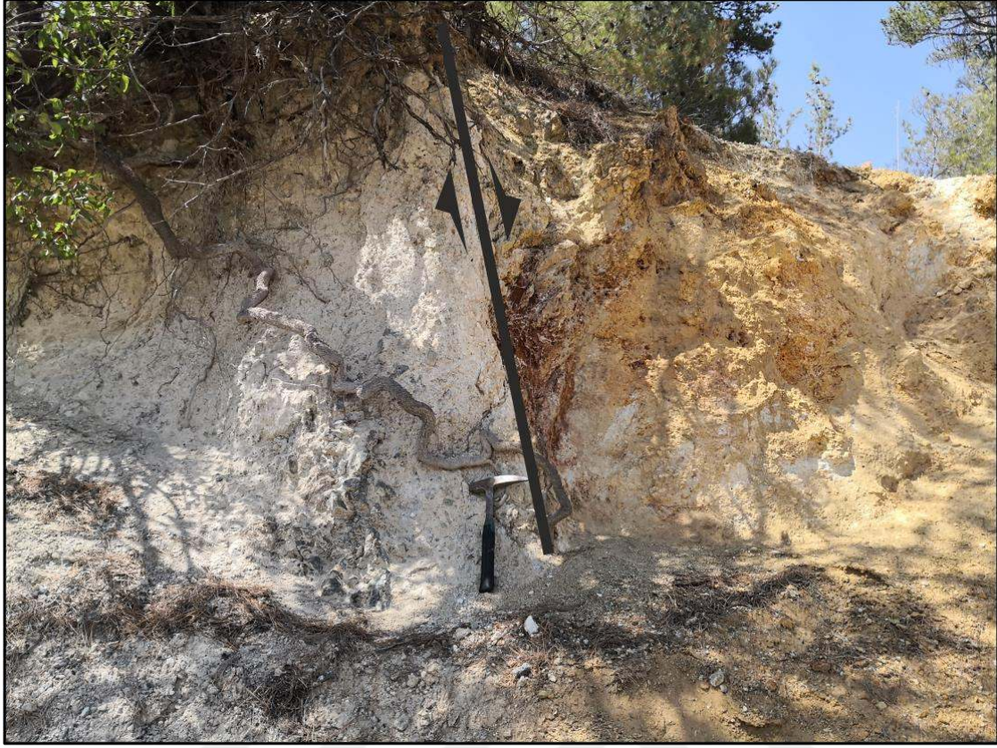
Şekil 6.8 Yeniköy Formasyonunu kesen fay düzlemi. Fay etkisi ile birimin alterasyona uğradığı görülmektedir.
