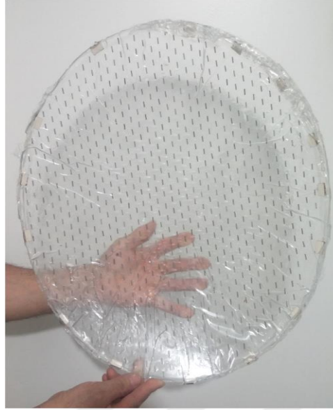
Şekil 5.10. Prototip üretimleri tamamlanan parabolik bant durduran FSY reflektör.
