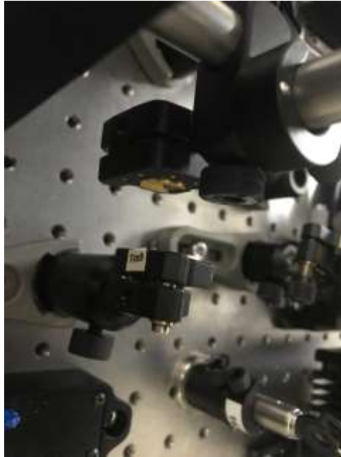
Şekil 21. Darbeli rejim çalışmaları için sisteme eklenen SESAM'nın şematik ve deneysel gösterimi
