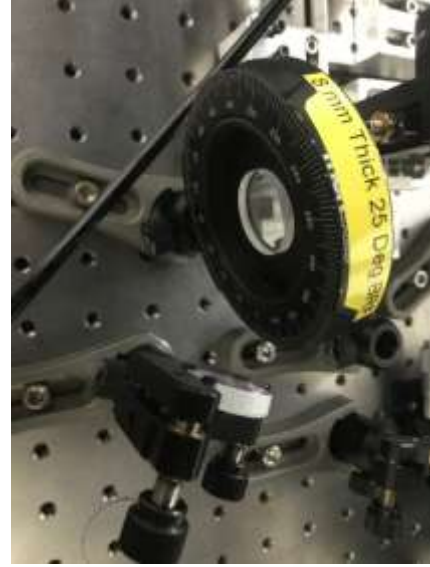
Şekil 20. Dalga boyu değişimi için sisteme eklenen ÇKP'nin şematik ve deneysel gösterimi
