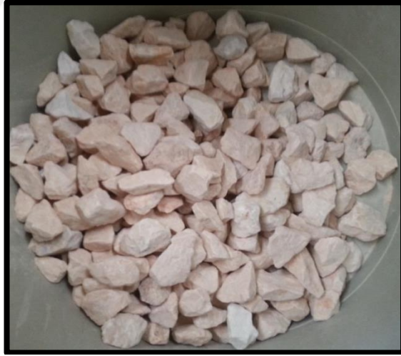
Şekil 5.1. Kalker kökenli iri tane boyutlu kırma taş agregat
