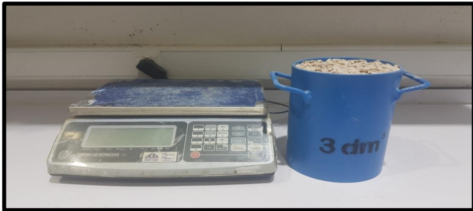
Şekil 5.8. Agreg a birim ağırlık deneyi
