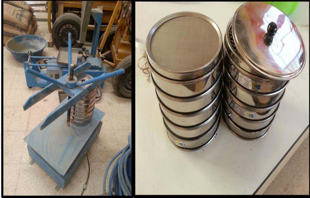
Şekil 5.7. Elek analizi deney düzeneği ve vibrasyon masası
