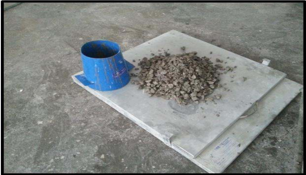
Şekil 5.12. Yayılma tablası deneyi
