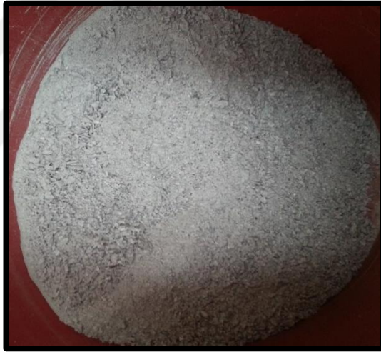
Şekil 5.3. İnce tane boyutlu granit agregası
