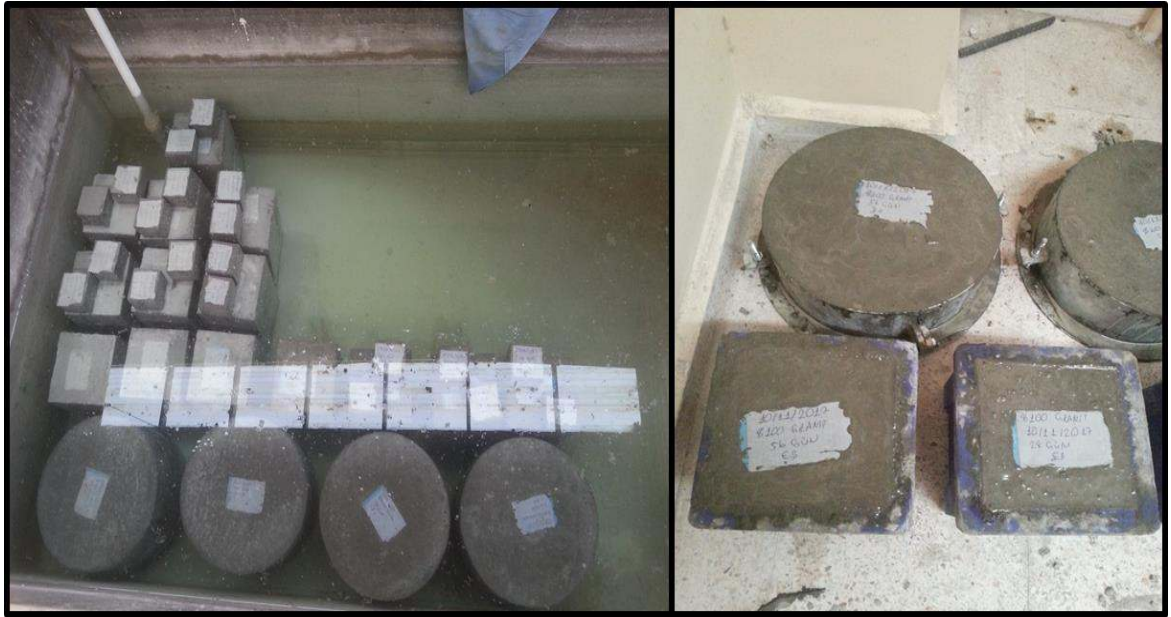
Şekil 5.19. Su altında bilyalı aşınma deney numunesi ve diğer numuneler
