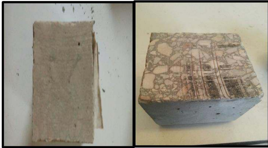
Şekil 6.6. Böhme aşınma deneyi öncesi ve sonrası
