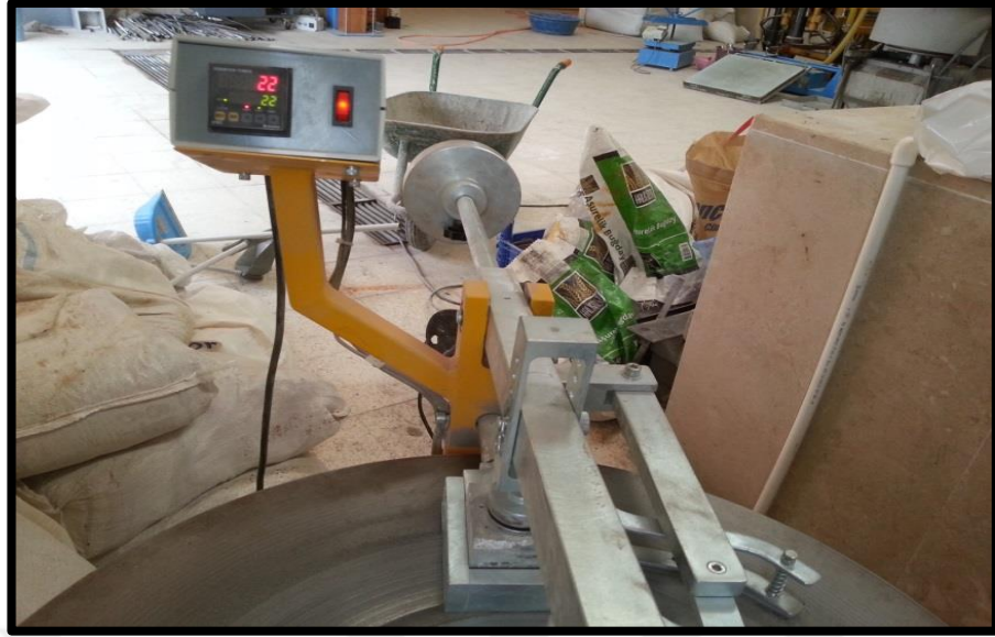
Şekil 5.15. Böhme aşınma deneyinin 22 tam devir sonrası bitişi
