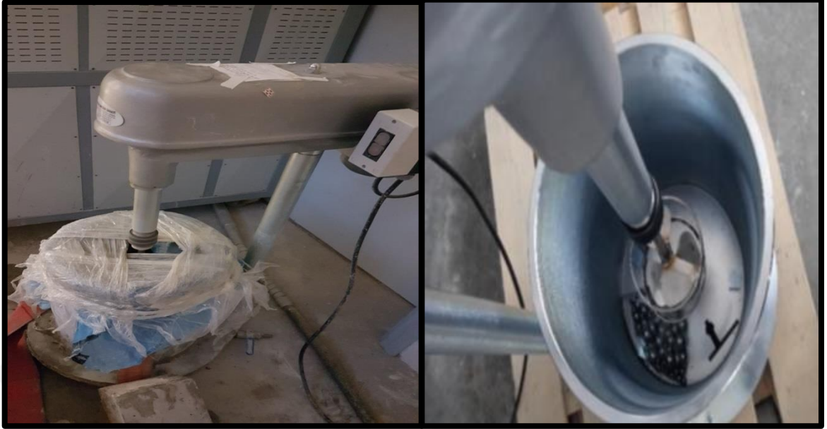
Şekil 5.18. Su altında bilyalı aşınma deney cihazı
