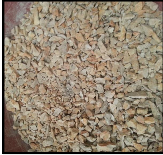
Şekil 5.2. Orta tane boyutlu kuvarsit agregası
