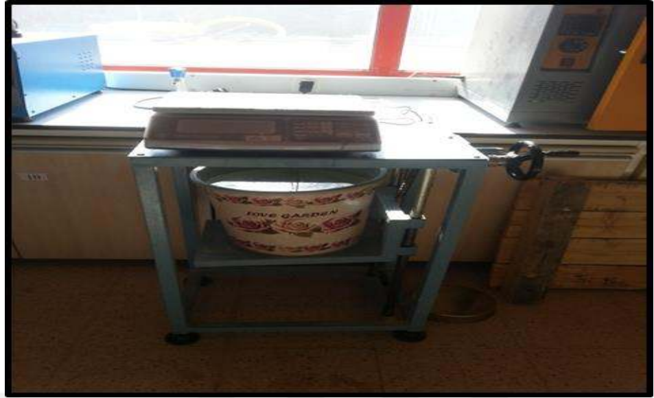
Şekil 5.9. İri agregaların özgül ağırlık tayini deney cihazı
