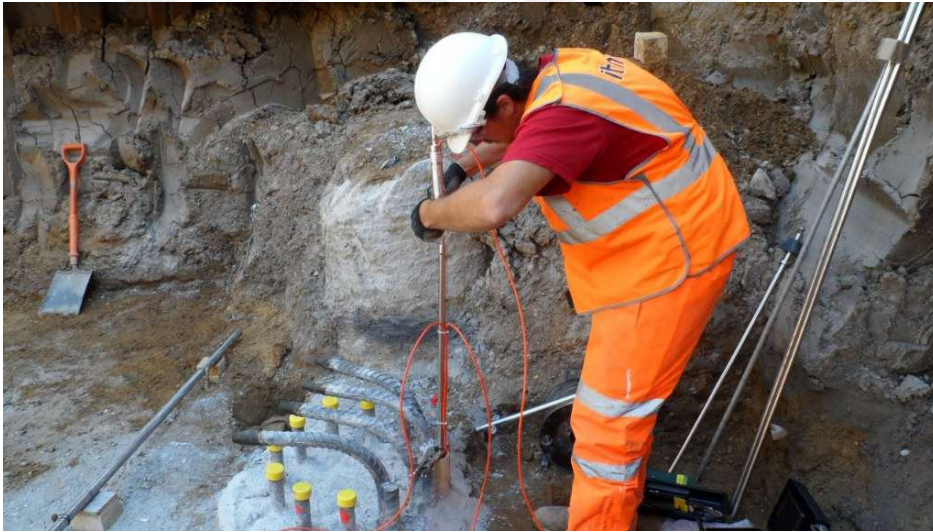
Şekil 26. Ekstansometre deneyi (Url 6).
