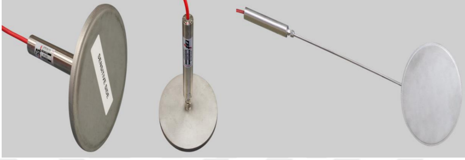
Şekil 28. Toplam basınç ölçer (Çetin ve Bilge, 2004: 1-10).
