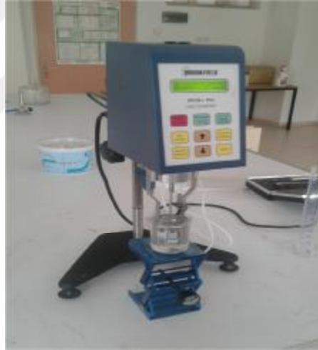
Şekil 4.13. Yağ ve tuzlu suyun Brookfield viskozimetre ile ölçülmesi
