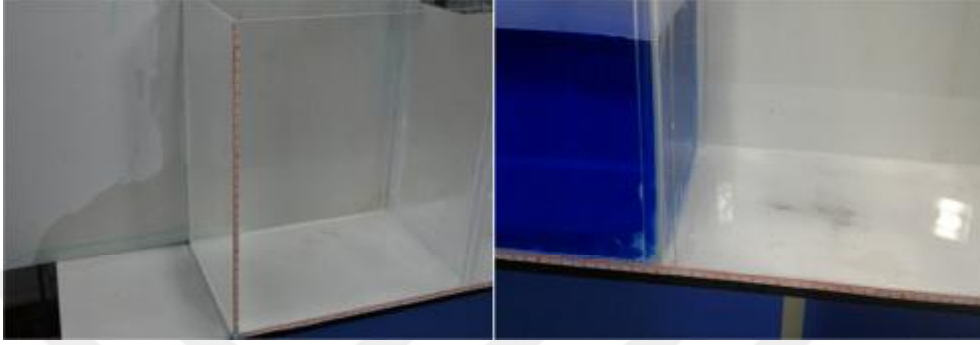
Şekil 4.10. Deney kanalının ölçülendirilmesi
