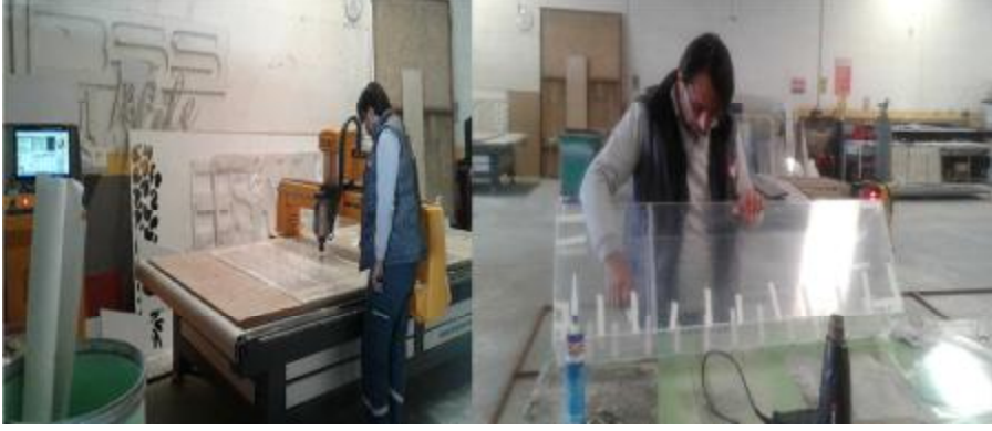
Şekil 4.2. Deney kanalının pleksiglas malzemeden teşkili
