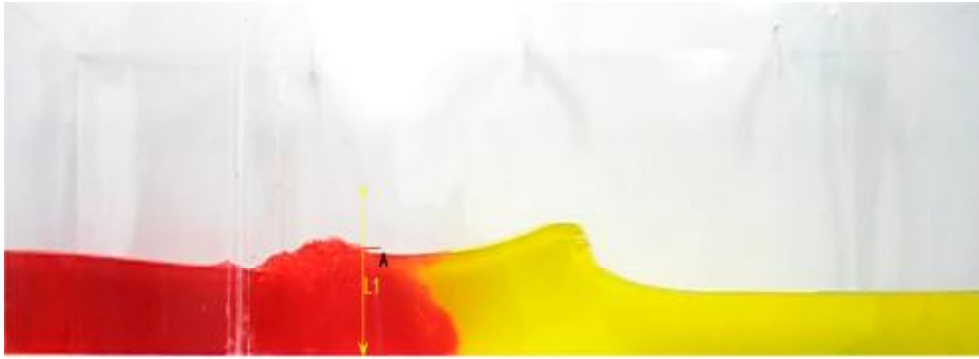
Şekil 4.27. Bir sanal derinlik ölçer örneği (Tuzlu Su-Tuzlu Su \alpha=0.40 için)
