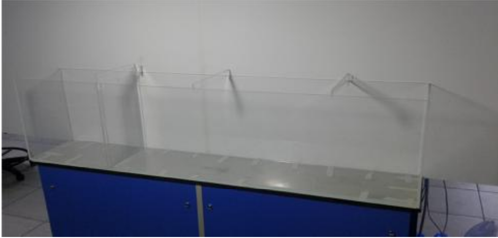
Şekil 4.3. Pleksiglas kelepçelerin oluşturulması ve konumlandırılması
