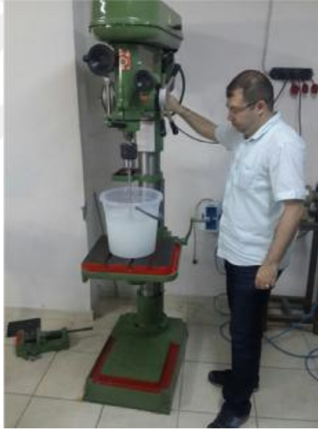
Şekil 4.15. Tuzlu suyun homojen dağılımı için tornada karıştırılması
