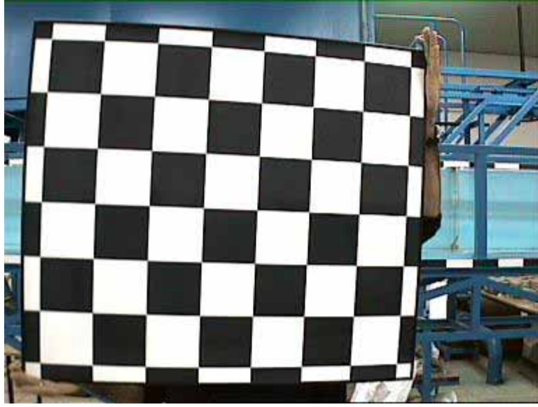
Şekil 4.5. Kalibrasyon panosu (Bombeli görünümde)
