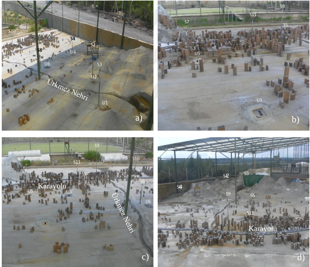
Şekil 3.30 (a) (b) (c) (d) Mansap bölgesine yerleştirilmiş olan seviye ölçerler ve UVP algılayıcıları (Kişisel arşiv, 2013)
