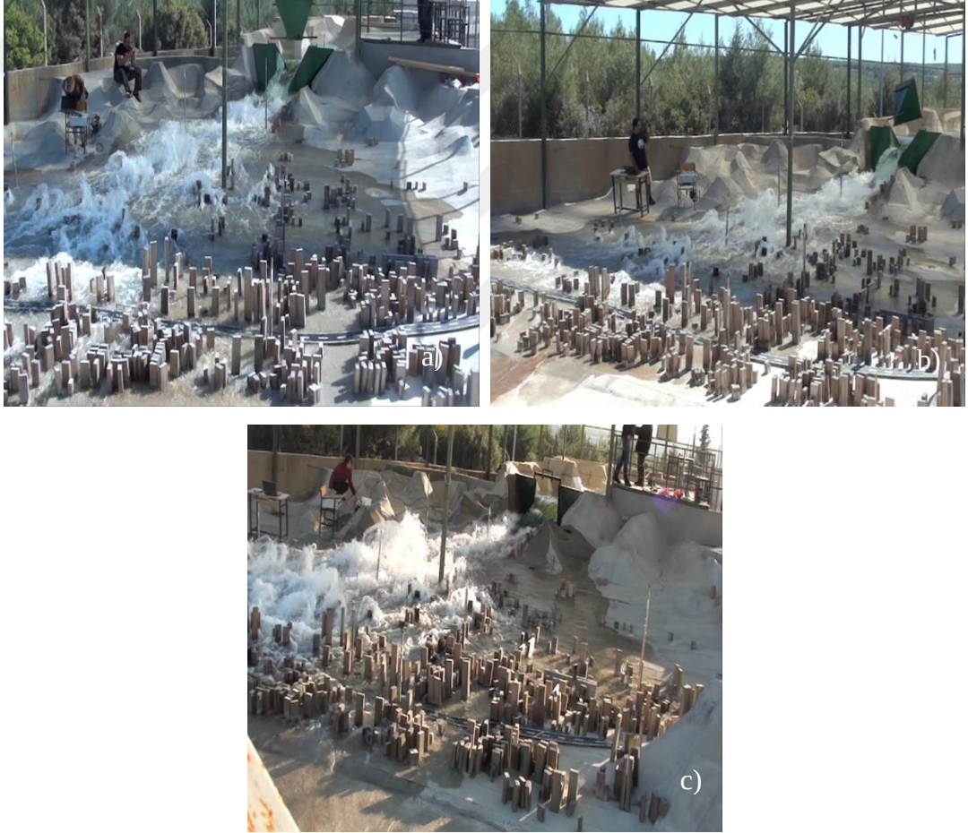
Şekil 4.21 12. saniyedeki kamera kayıtları (a) trapez, (b) üçgen yıkılma ve (c) ani yıkılma (Kişisel arşiv, 2013)
