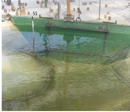
Şekil 3.29 Baraj gölüne yerleştirilen seviye ölçer (Kişisel arşiv, 2013)
