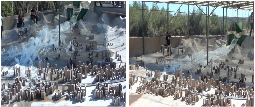
Şekil 4.20 6. saniyedeki kamera kayıtları (a) trapez, (b) üçgen ve (c) ani yıkılma (Kişisel arşiv, 2013)
