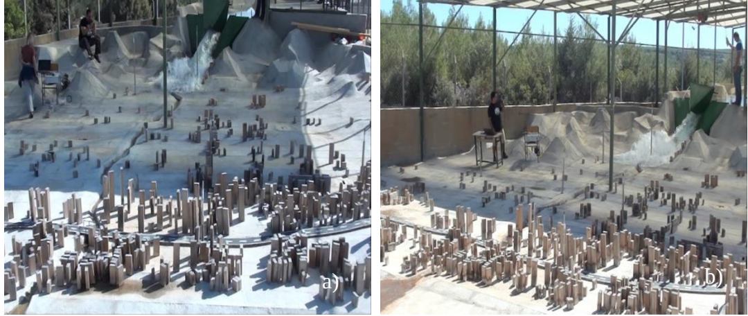
Şekil 4.17 1. saniyedeki kamera kayıtları (a) trapez, (b) üçgen ve (c) ani yıkılma (Kişisel arşiv, 2013)
