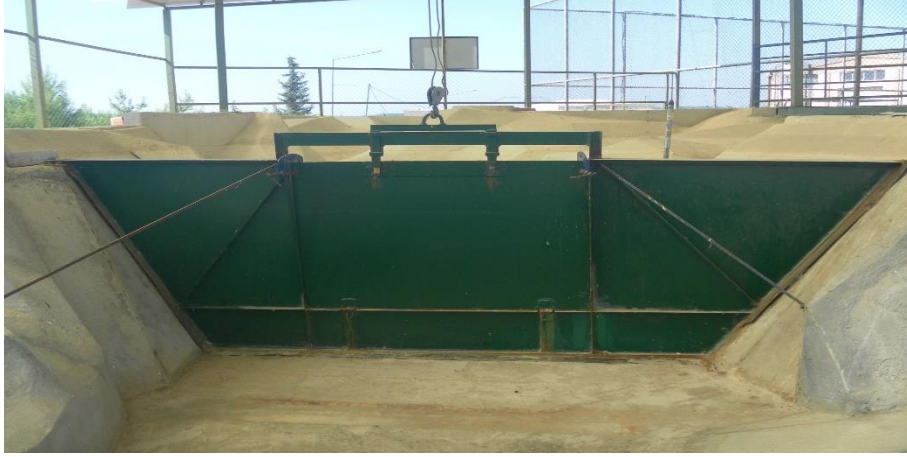
Şekil 3.20 Ani yıkılma baraj kapağı düzeneği (Kişisel arşiv, 2013)
