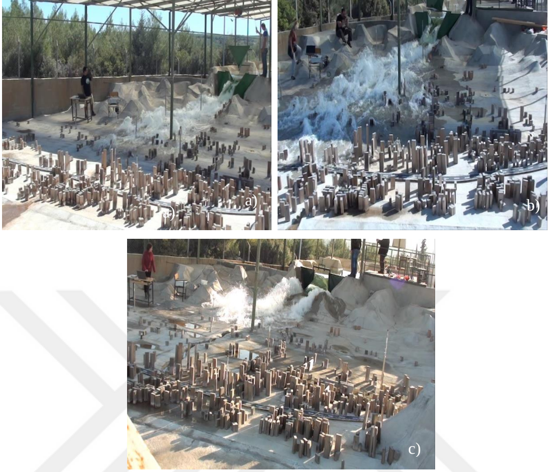
Şekil 4.19 4. saniyedeki kamera kayıtları (a) trapez, (b) üçgen ve (c) ani yıkılma (Kişisel arşiv, 2013)
