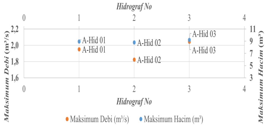
Şekil 4.12 Ani yıkılma deneyleri için maksimum debi - hacim - hidrograf gruplandırması
