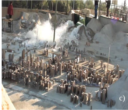
Şekil 4.18 2. saniyedeki kamera kayıtları (a) trapez, (b) üçgen ve (c) ani yıkılma (Kişisel arşiv, 2013)
