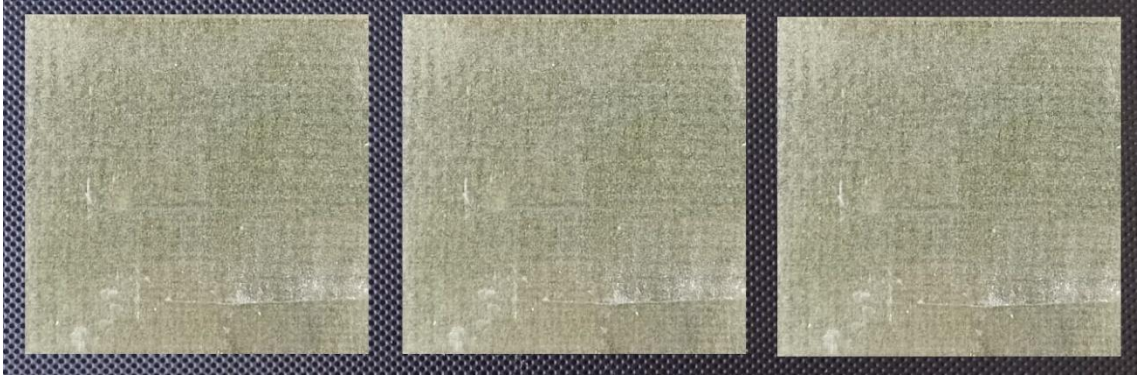
Şekil 3.6. Ağırlık düşürme deneyi için hazırlanan numuneler
