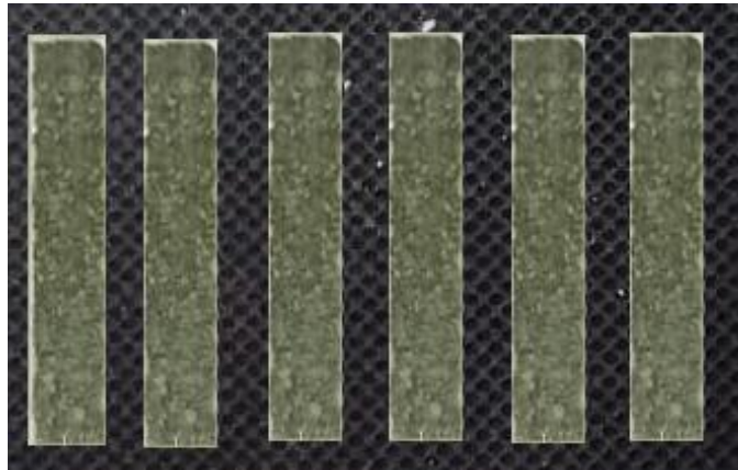
Şekil 3.8. Charpy darbe deneyi için hazırlanan numuneler
