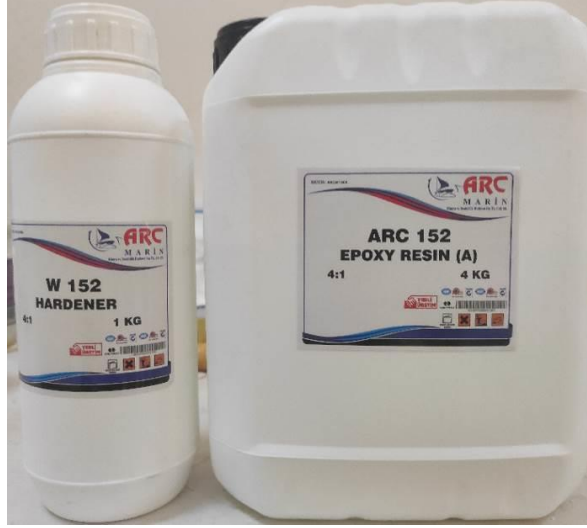
Şekil 3.2. Epoksi set (ARC 152 reçine ve W 152 sertleştirici)
