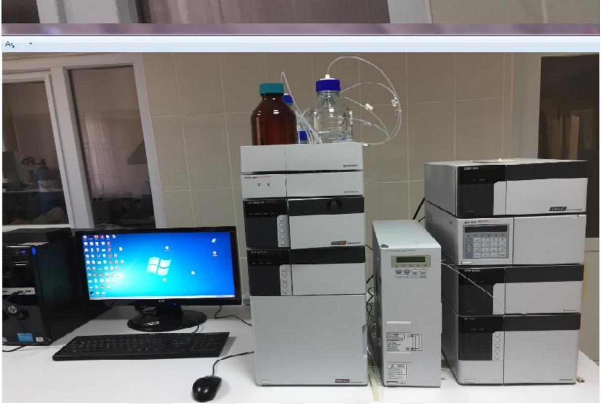
Resim 1: Yüksek Basıncılı Sıvı Kromatografisi (HPLC) cihazı ve ekipmanları
