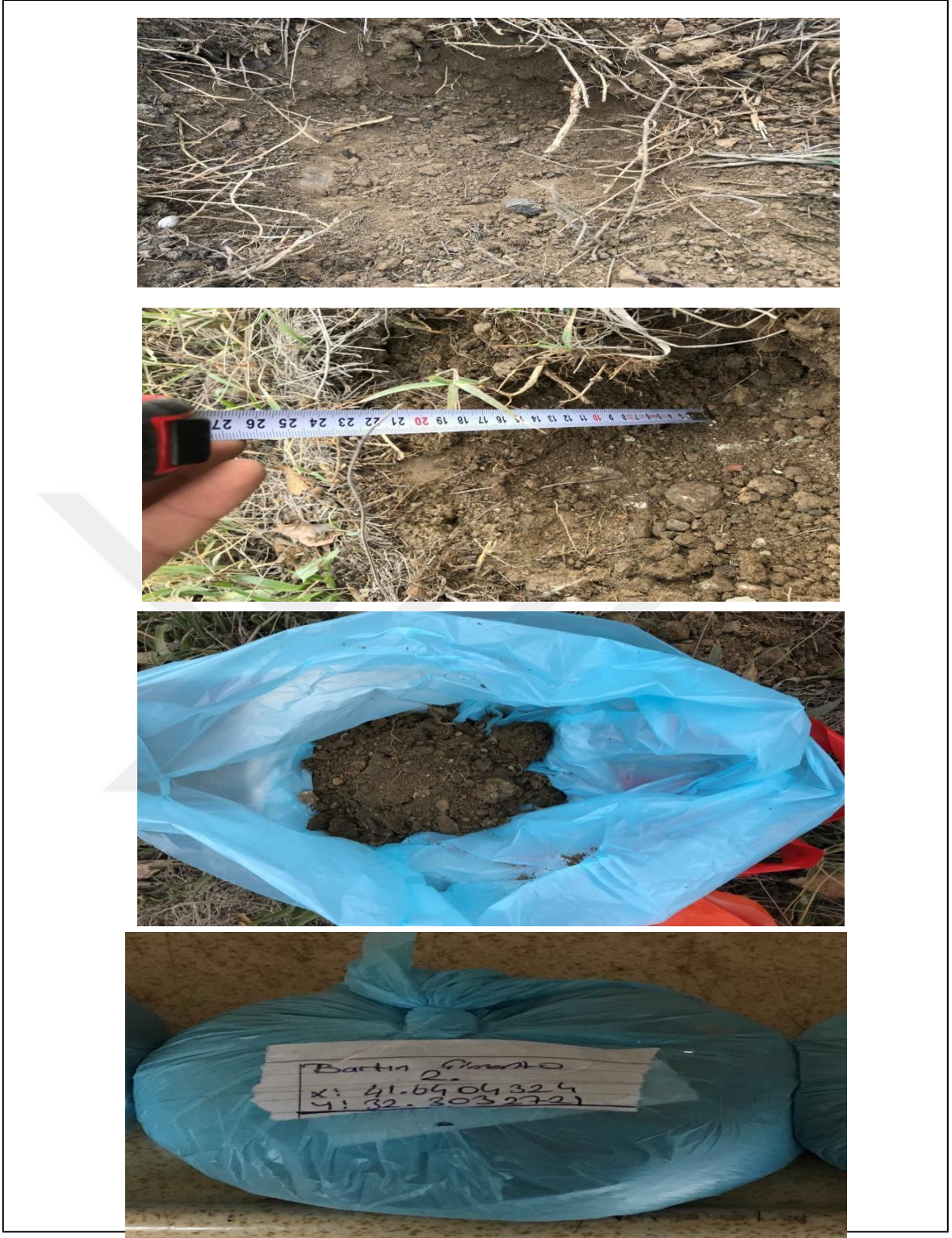
Şekil 1.5: Toprak örneklerinin alınması, poşetlenmesi ve etiketlenmesi. (Bartın Çimento)
