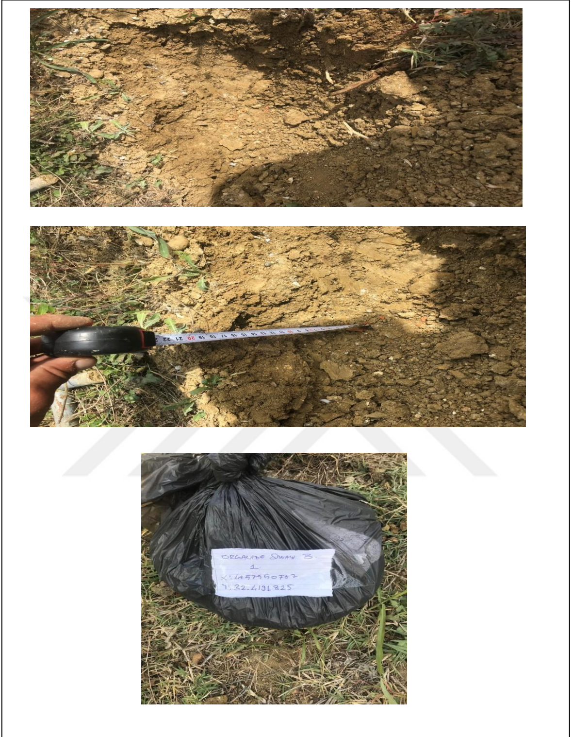
Şekil 1.9: Toprak örneklerinin alınması, poşetlenmesi ve etiketlenmesi. (Bartın OSB)
