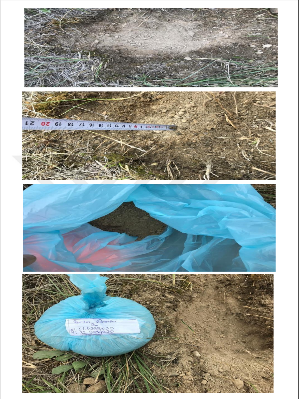
Şekil 1.6: Toprak örneklerinin alınması, poşetlenmesi ve etiketlenmesi. (Bartın Çimento)
