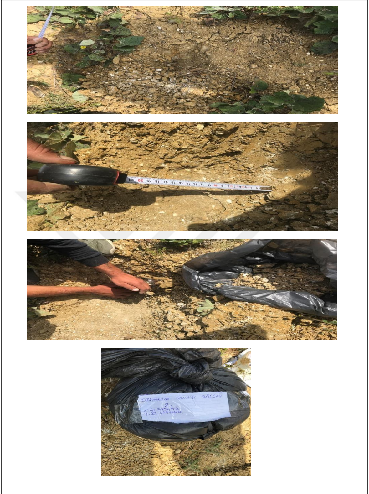
Şekil 1.10: Toprak örneklerinin alınması, poşetlenmesi ve etiketlenmesi. (Bartın OSB)
