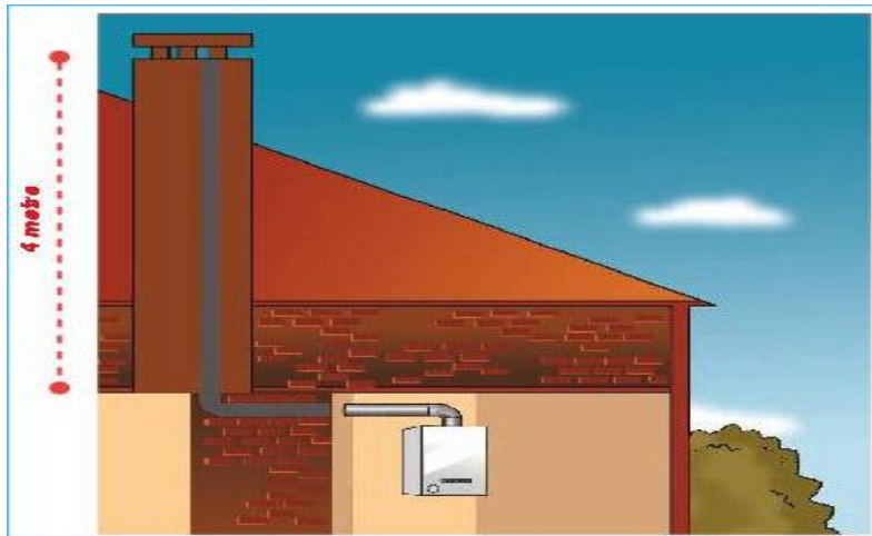
Şekil 3.7 Bacalı kombi şematik görünümü (URL-9).
