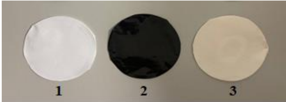
Şekil 4.4. Elde edilen 1) PVDF/BT, 2) PVDF/BT@PANI ve 3) PVDF/BT-APS kompozit filmleri
