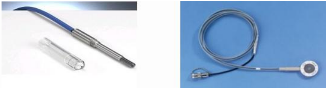
Şekil 2.10. Silindirik İyon Odası, Farmer Tipi 0,6 cc ve Paralel Düzlem İyon Odası, Wellhöfer PPC 40
