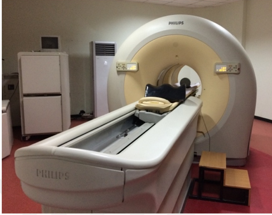
Şekil 19: Elektron Yoğunluğu Fantomunun PET-BT Cihazında Taraması
