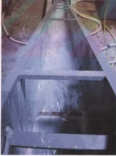
Şekil 6.17 Yüksekliği 4 cm olan dikdörtgen en kesitli eşğin tüm basamaklara yerleştirilmesi ile oluşan basamaklı dolusavak
