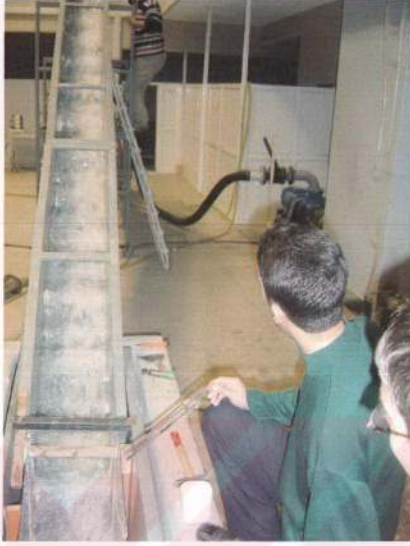
Şekil 6.13 Yüksekliği 4 cm olan dikdörtgen en kesitli eşğin bir basamak dolu, bir basamak boş olacak şekilde yerleştirilmesi ile elde edilen basamaklı dolusavak.
