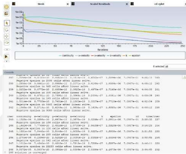
Şekil 3.12. Realizable k-\epsilon Non Equilibrium Türbülans Modeli Kullanılarak Model-A Normalize Edilmiş Artıklar Grafiği
