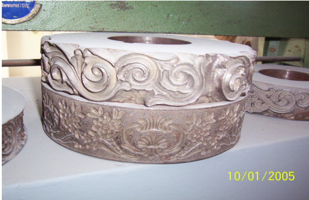
Resim 5.23. Çok derinlikli ve az derinlikli oyma yapan bıçaklar [28]
