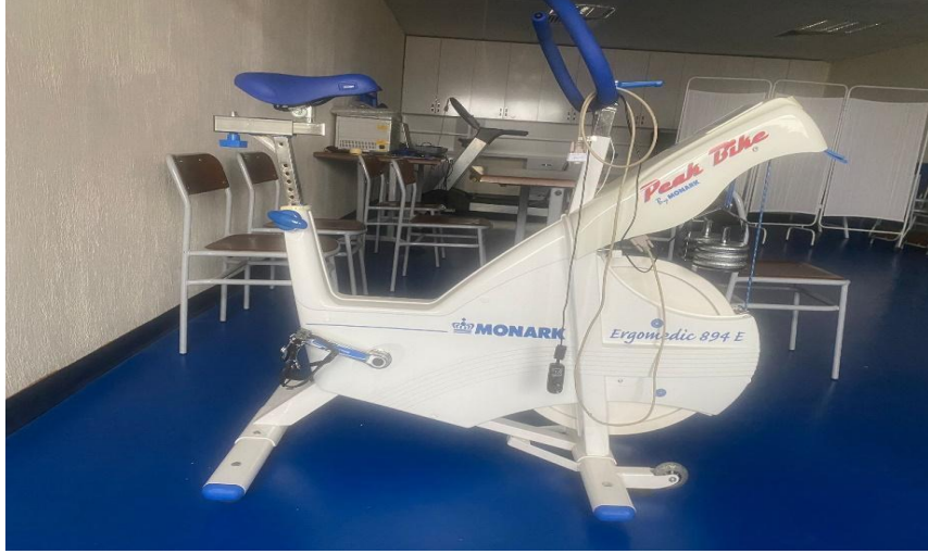
Görsel 3.5. Wingate anaerobik güç testi bisikleti
