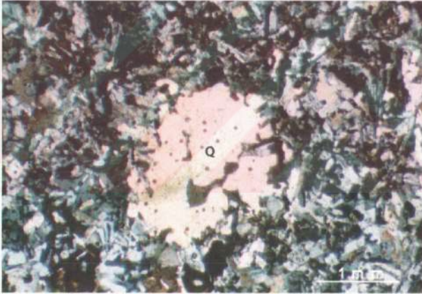
Şekil 3.11. Mafik mikrogranüler anklavlar içerisinde gözlenen kuvars ksenolitinin a) tek nikoldeki, b) çift nikoldeki görünümü. Q: kuvars
