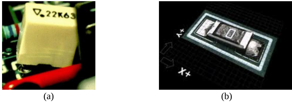
Şekil 1.2 a) Delikli lehimleme yapılan bileşenlerde karşılaşılan kalkık malzeme hatası örneği, b) Yüzey montajlı bileşenlerde görülen kalkık malzeme hatası örneği.
