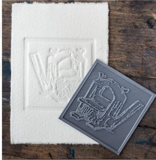
Görsel 3.22. Lazer Kesim Kalıp ve Baskı Örneği.
