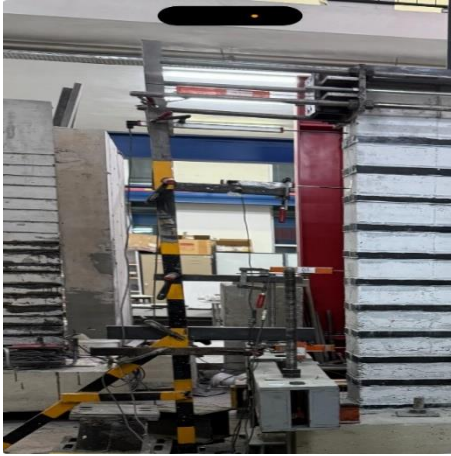
Şekil 29. Deney Düzeneği, LVDT ve Data Logger Cihazı Görselleri
