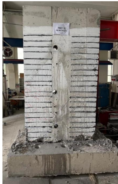
Şekil 18. Perde Elemanlardan Deney Sonrası Alınan Karot Çalışması
