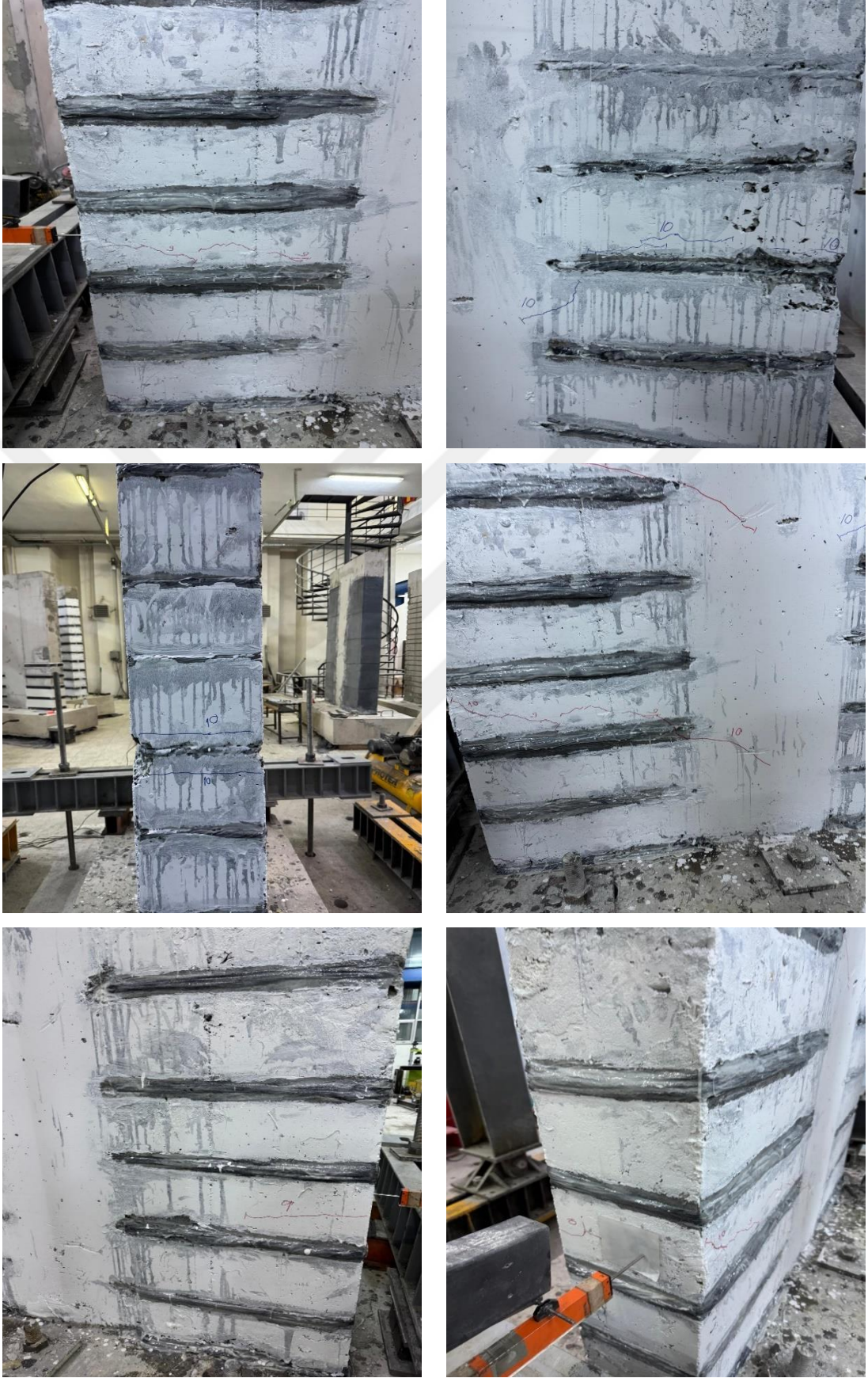
Şekil Ek3-1. 9. ve 10. Adım İlk Oluşan Çatlaklar
