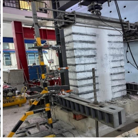
Şekil 29. Deney Düzeneği, LVDT ve Data Logger Cihazı Görselleri
