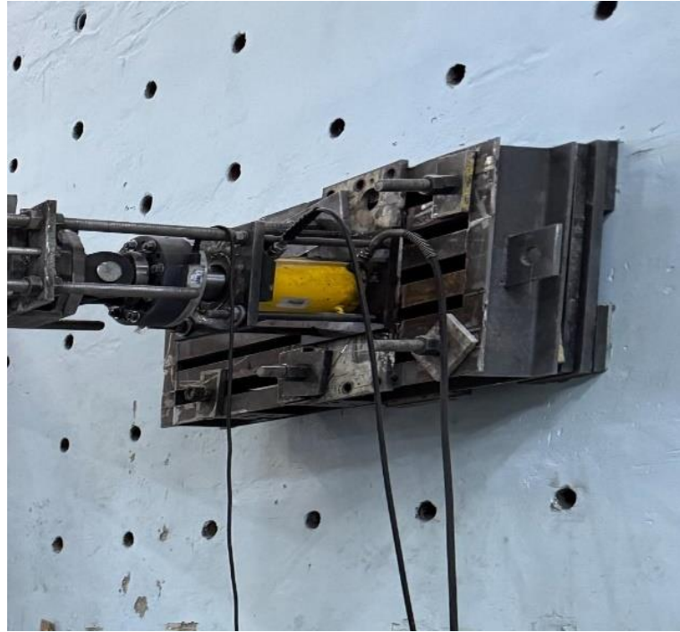
Şekil 27. Yatay ve Düşey Yükleme Düzeneği Yerleşimi
