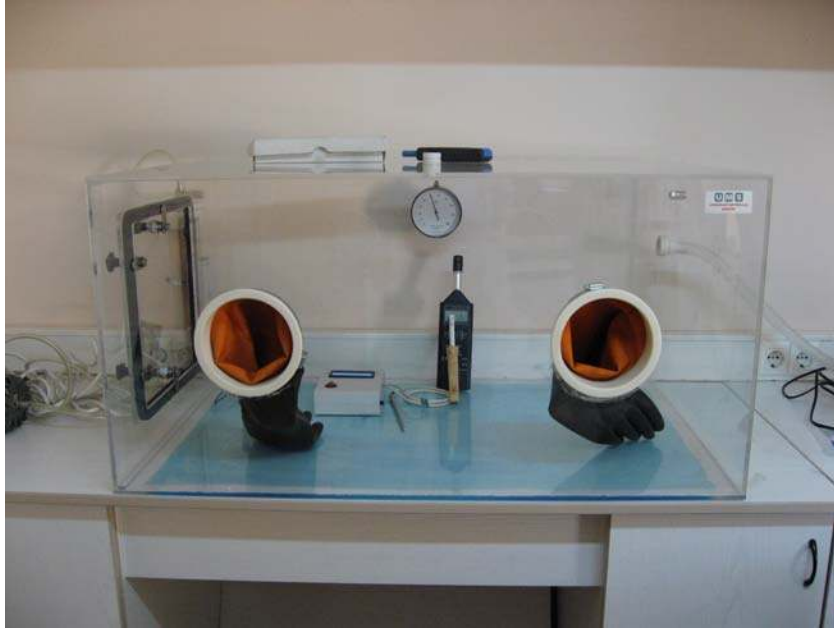
Şekil 3.16 Nem testi düzeneği ( Nem üretme cihazından önce )
