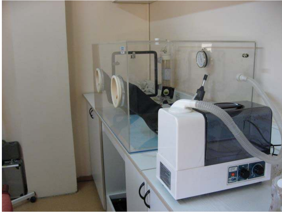
Şekil 3.18 Nem testi düzeneği ( Nem üretme cihazıyla beraber )
