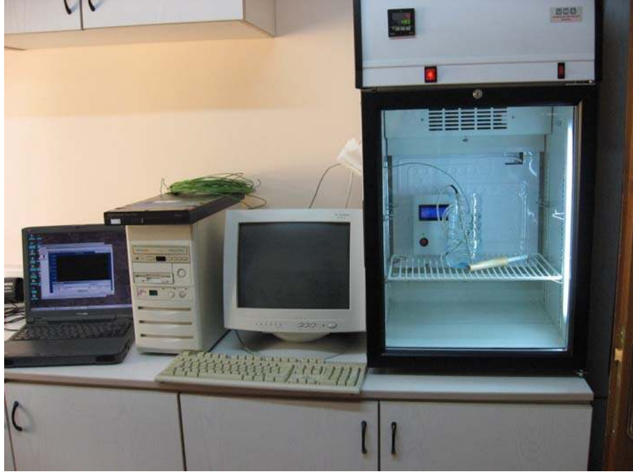
Şekil 3.14 Solarton ile BNS 1.0 cihazlarının karşılaştırılma test düzeneği
