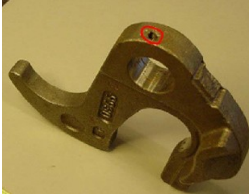
Şekil 5.12 Yanlış konumlandırma sonucu üründe yaşanan havalandırma sorunu
