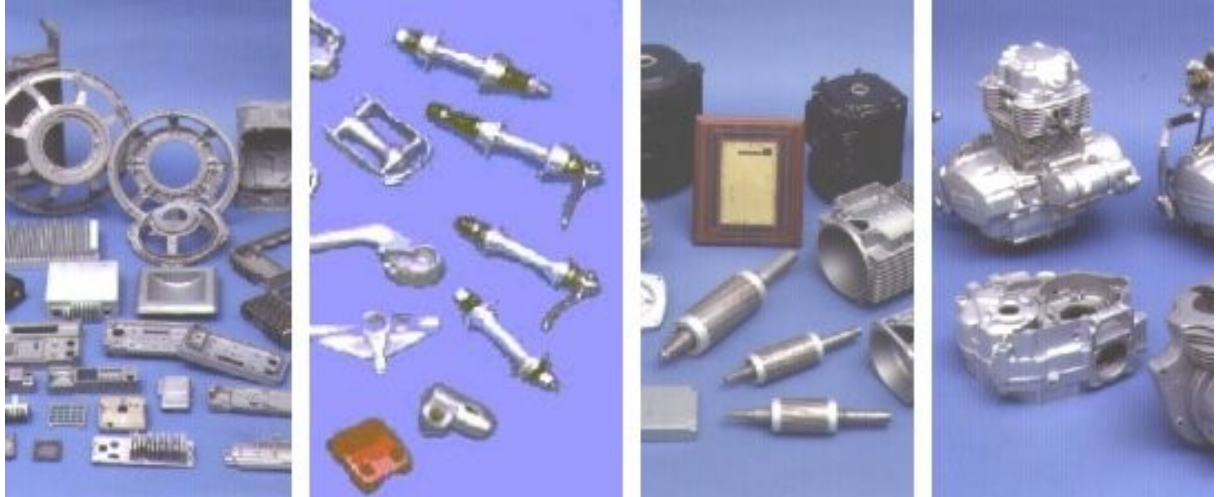
Şekil 1.1 Basınçlı Dökümle Üretilen Ürünler (Karataş ve Kahraman 2003)
