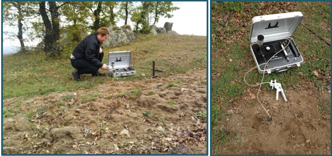
Resim 3.4 Yerinde toprak gazı radon ölçümü ve ölçüm sistemi.
