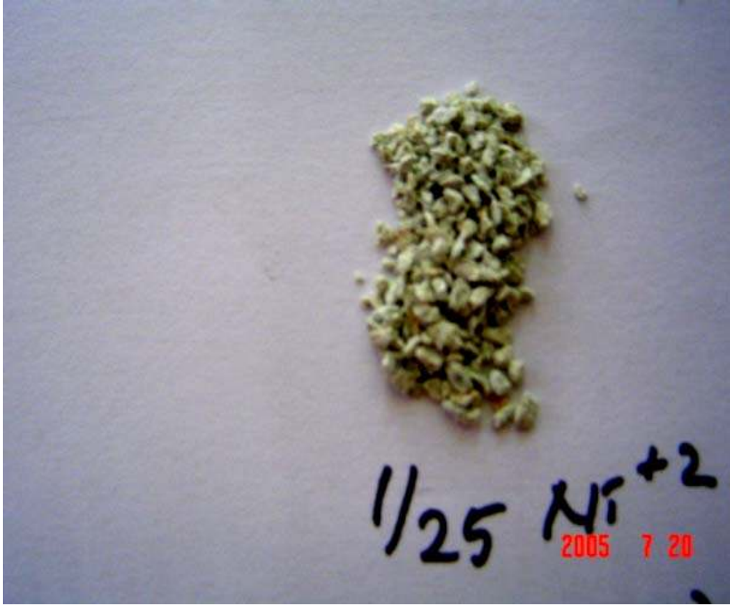
Resim 6.9. g sodyum formundaki klinoptilolit / mL nikel nitrat çözeltisi oranı 1 / 25 olan denge deney sonucunda kuru klinoptilolit görüntüsü
