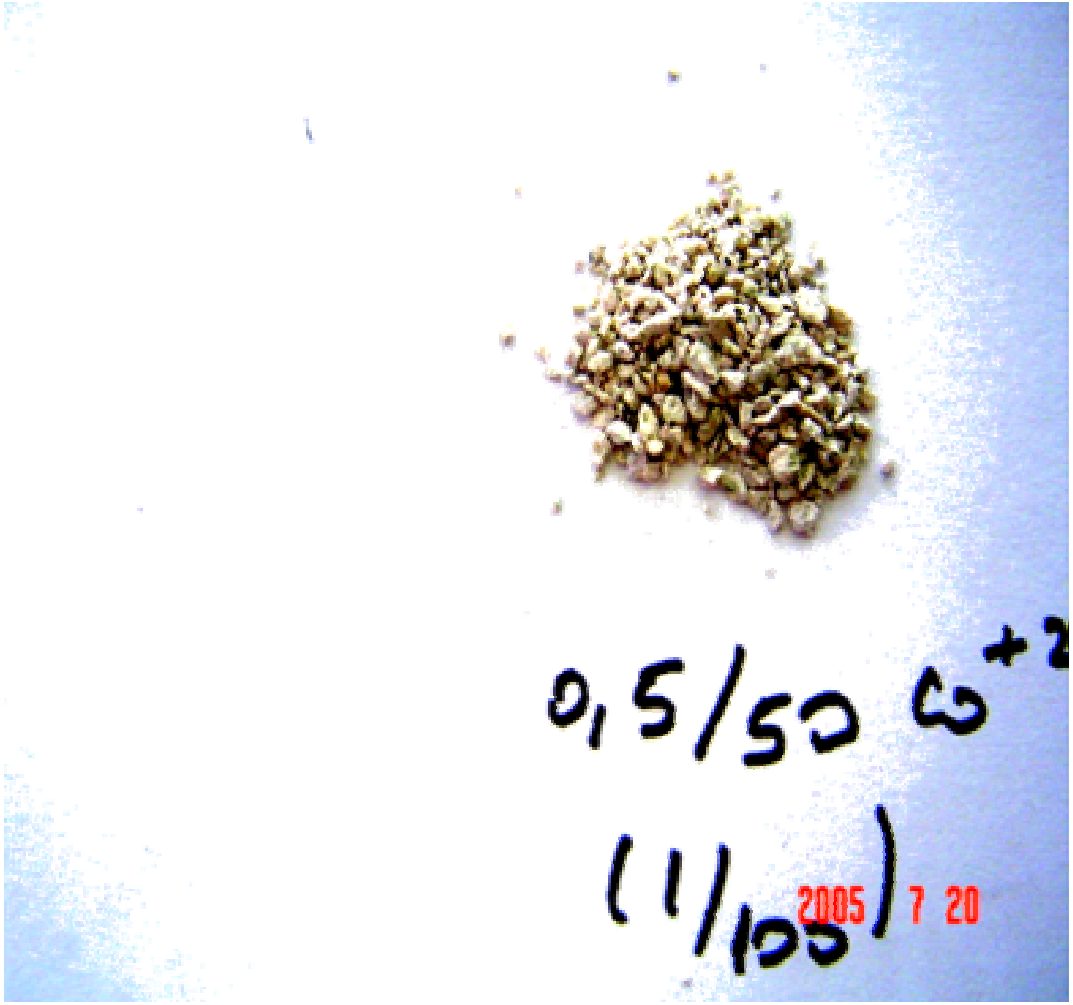
Resim 6.8. g sodyum formundaki klinoptilolit / mL kobalt nitrat çözeltisi oranı 0,5 / 50 olan denge deneyi sonucunda kuru klinoptilolitin görüntüsü
