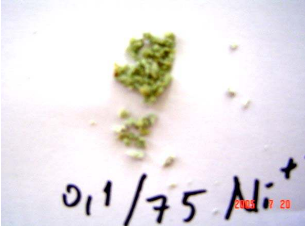
Resim 6.3. g sodyum formundaki klinoptilolit / mL nikel nitrat çözeltisi oranı 1 / 250 olan denge deneyi sonucunda ıslak klinoptilolitinin görüntüsü
