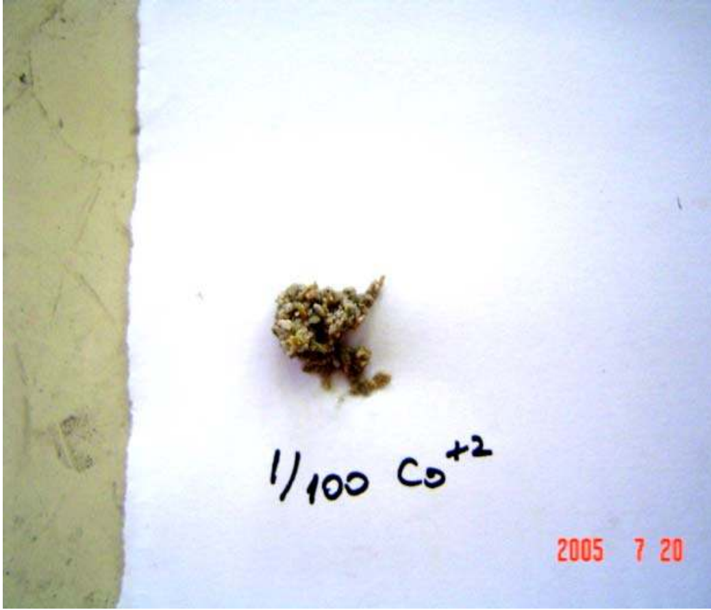
Resim 6.6. g sodyum formundaki klinoptilolit / mL kobalt nitrat çözeltisi oranı 1 / 100 olan denge deneyi sonucunda ıslak klinoptilolit görüntüsü
