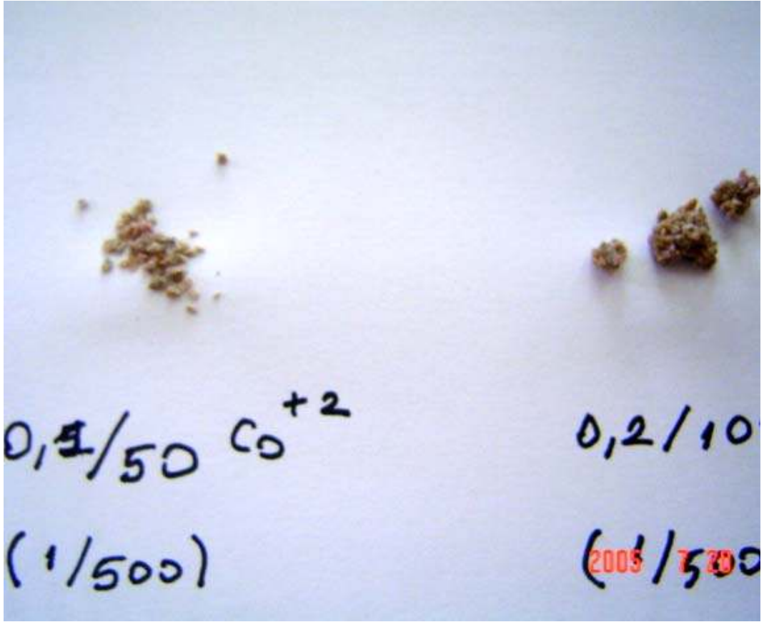
Resim 6.4. g sodyum formundaki klinoptilolit / mL kobalt nitrat çözeltisi oranı 0,1 / 50 ve 0,2 / 100 olan denge deneyleri sonucunda ıslak klinoptilolitlerin görüntüleri
