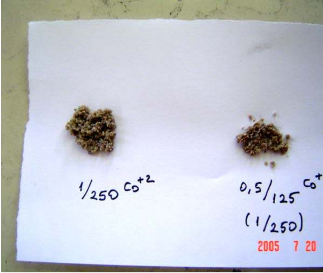
Resim 6.5. g sodyum formundaki klinoptilolit / mL kobalt nitrat çözeltisi oranı 1 / 250 ve 0,5 / 125 olan denge deneyleri sonucunda ıslak klinoptilolitlerin görüntüleri
