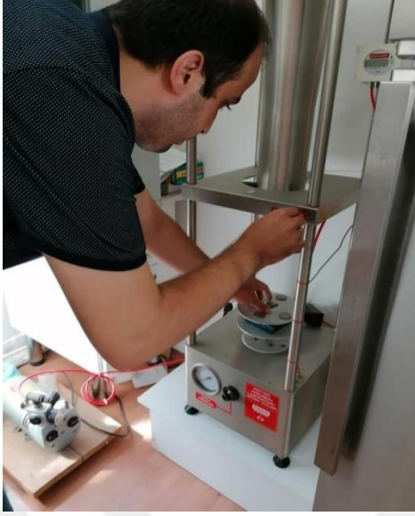
Şekil 3.7. Spor süspansiyonlarının yaprakların üzerinde bulunan trips ergin bireylerine ilaçlama kulesi (spray-tower) kullanılarak püskürtülmesi
