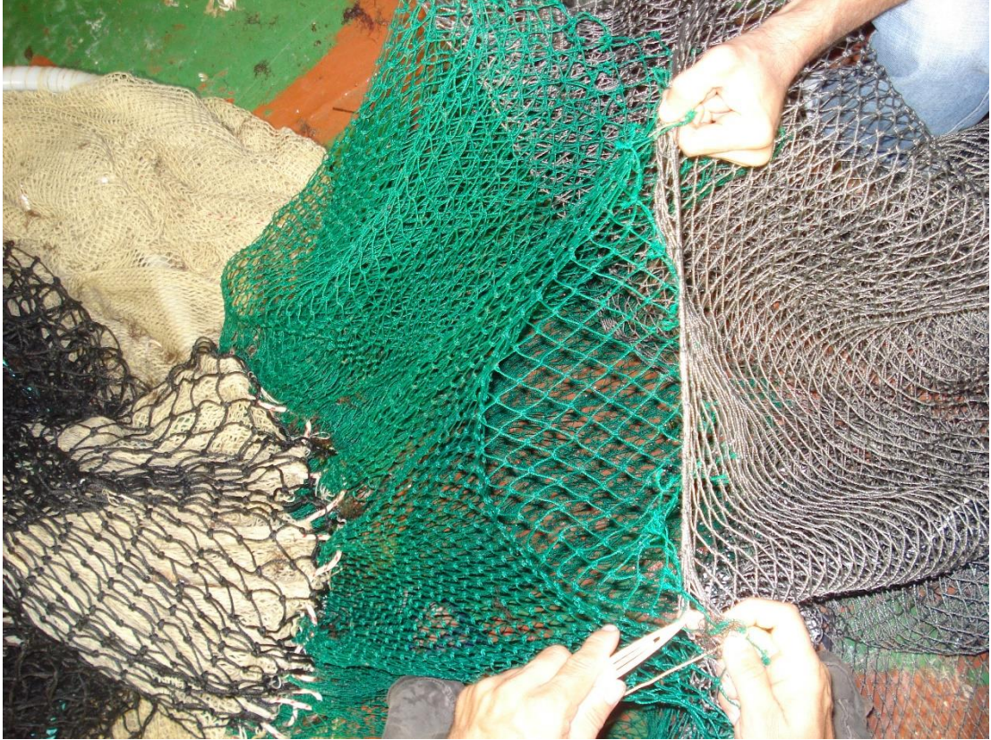
Şekil 3.5: Balıkçılık denemelerinde kullanılan dip trol ağlarının donatılması.
