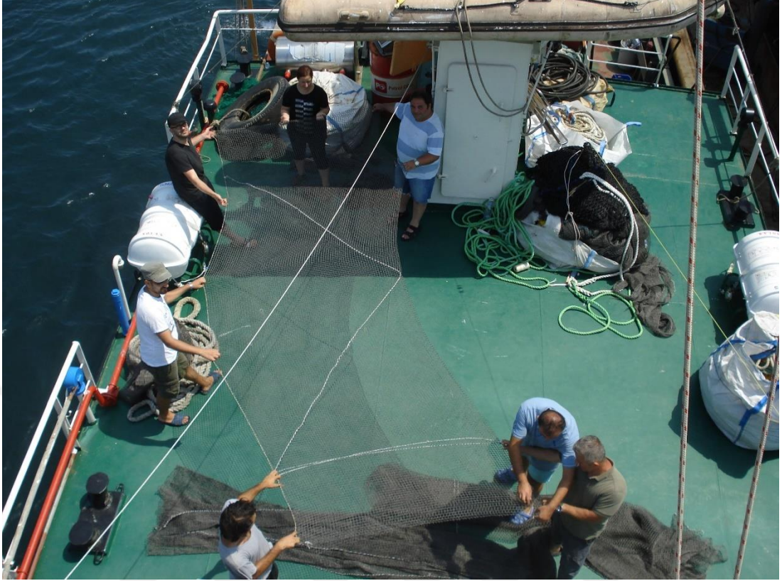
Şekil 3.4: Balıkçılık denemelerinde kullanılan dip trol torbalarının hazırlanması.
