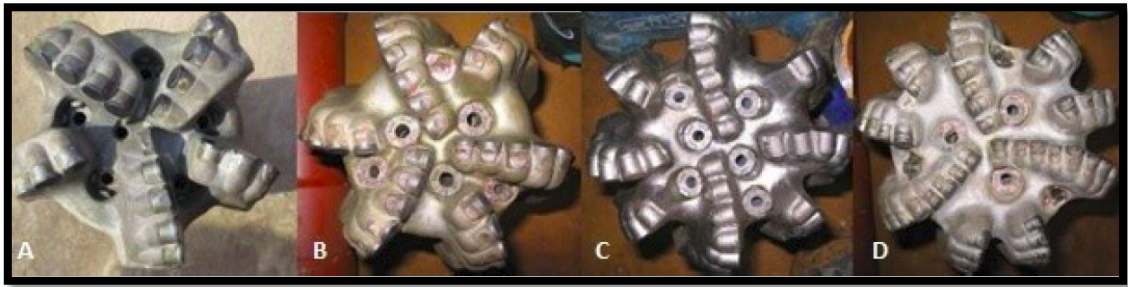
Şekil 3.44. Kayaçların sertliğine bağlı olarak PDC matkaplarının tasarımı (yumuşak A'dan sert D'ye) (Górski, 2007)
