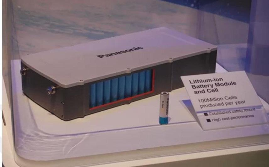
Şekil 2.2 Batarya hücresi ve modülü
