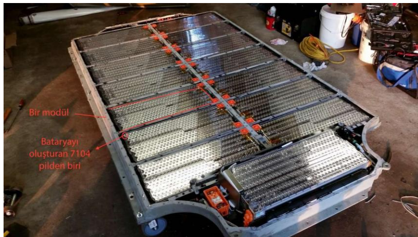
Şekil 2.3 Tesla marka bir araca ait batarya paketi
